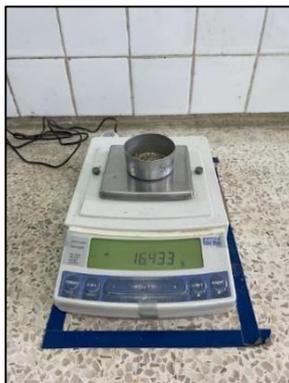
**Figura 17.** Pesaje de muestra seca de suelo
