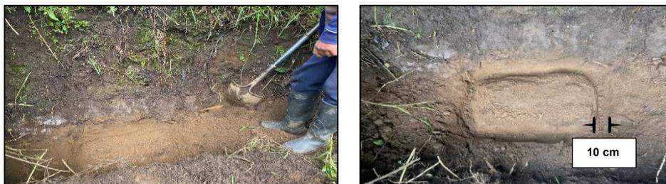
**Figura 6.** Excavación del cubo de suelo
