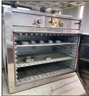
**Figura 16.** Secado de la muestra en el horno
