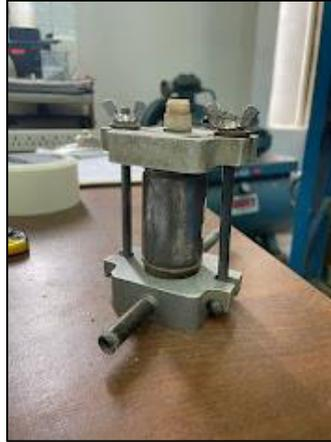
**Figura 13.** Muestra de suelo en el interior del molde asegurado
