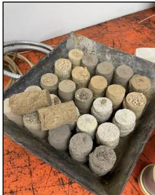
**Figura 12.** Muestras de suelo luego de haber sometidas al ensayo triaxial
