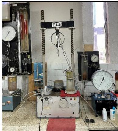
**Figura 11.** Cámara Triaxial
