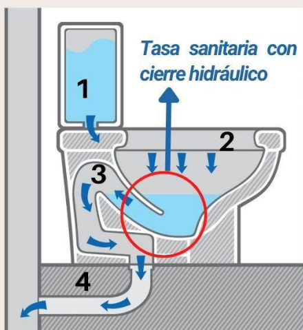
Fig. 2: Baño de arrastre hidráulico
