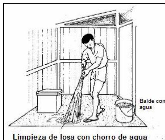
Figura 7. Mantenimiento del baño de arrastre hidráulico,
