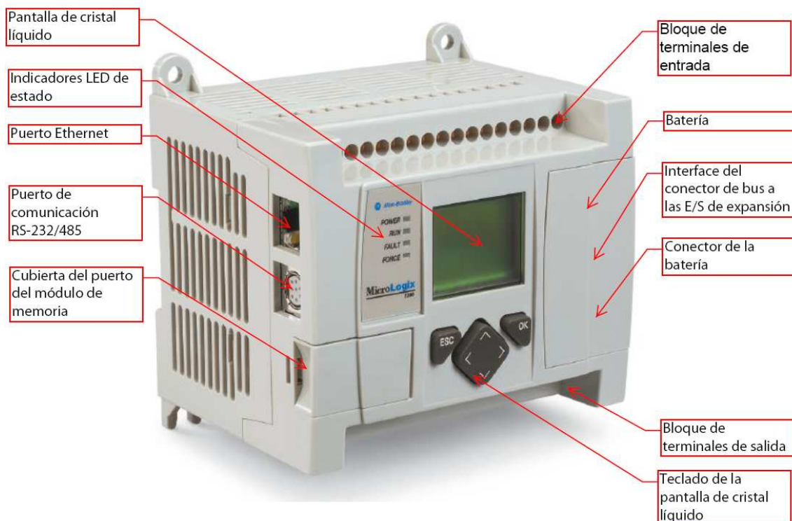
Figura 1-12. Partes del controlador Micrologix™ 1100 13
