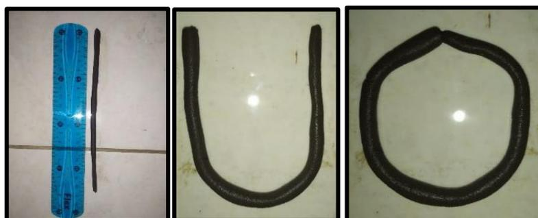
**Figura 8.** Ejecución del ensayo de manipulación de tira extendida.
