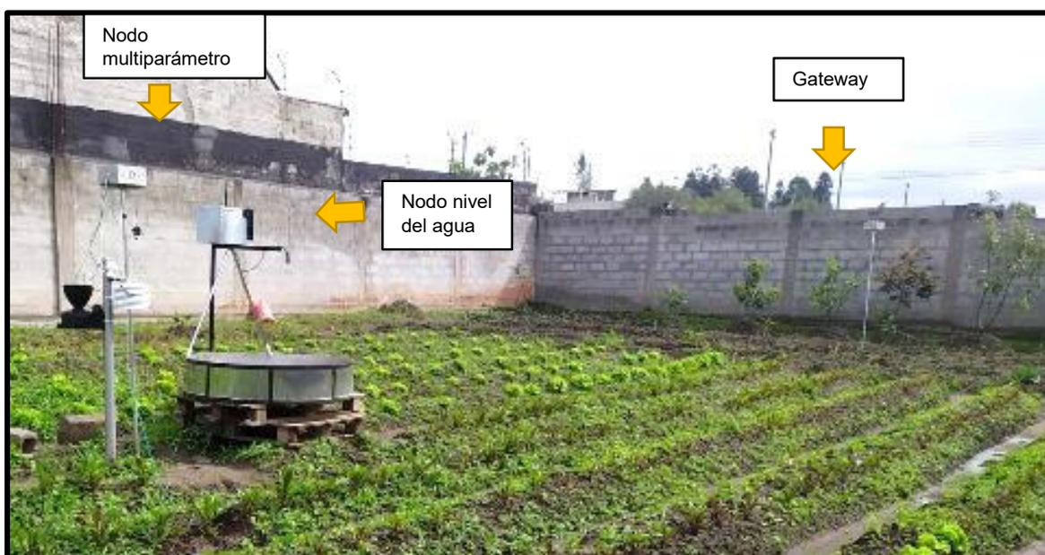
**Figura 53.** Disposición de los nodos y el Gateway en el sitio experimental de estudio.
