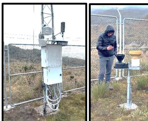
**Figura 19.** Sensores Davis #6466M y Davis #6830 instalados junto a los sensores de la estación M5025 del FONAG.
