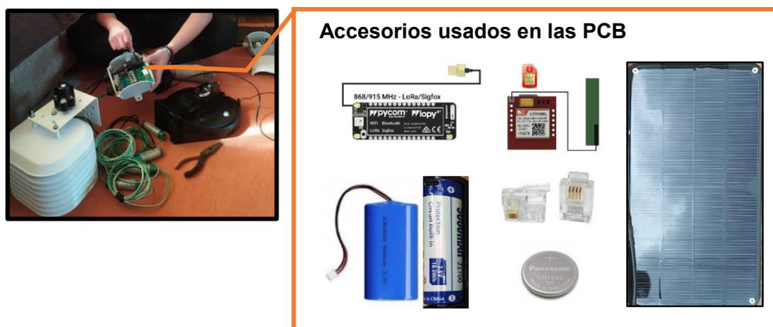
**Figura 14.** Ensamblaje del hardware del sistema IoT-LoRa, con sus respectivos accesorios: módulo Lopy4, módulo GPRS sim800L, pila CR-1220 de 3V, baterías de litio de 3.7 V, conectores RJ11 y un panel solar.
