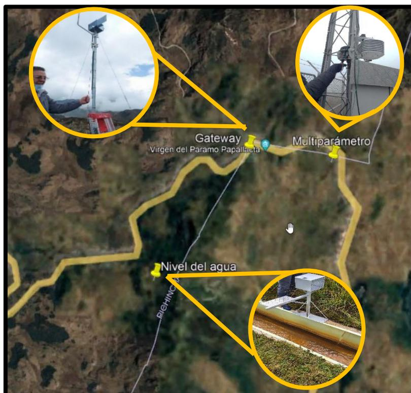
**Figura 18.** Ubicación de los nodos y Gateway en la zona experimental de Paluguillo.
