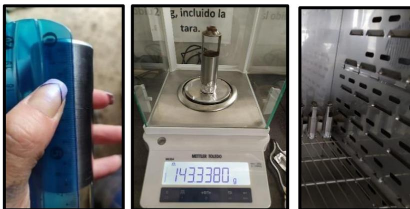
**Figura 42.** Ensayo para la determinación de la densidad aparente.
