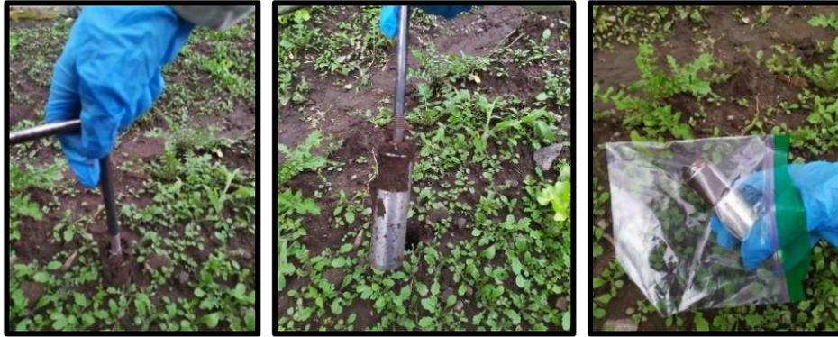
**Figura 41.** Toma de muestras de suelo en campo mediante los anillos Kopecky.
