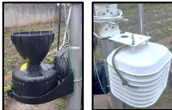
**Figura 37.** Sensores de precipitación (Davis #6466M) y de temperatura y humedad relativa (Davis #6830) ensamblados e instalados en campo.
