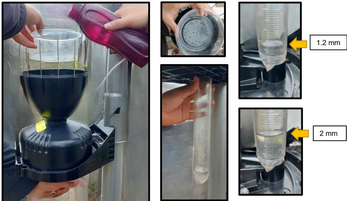
**Figura 23.** Comprobación de la resolución e intensidad soportada por el sensor de precipitación Davis #6466M mediante el uso de una probeta graduada en mm.
