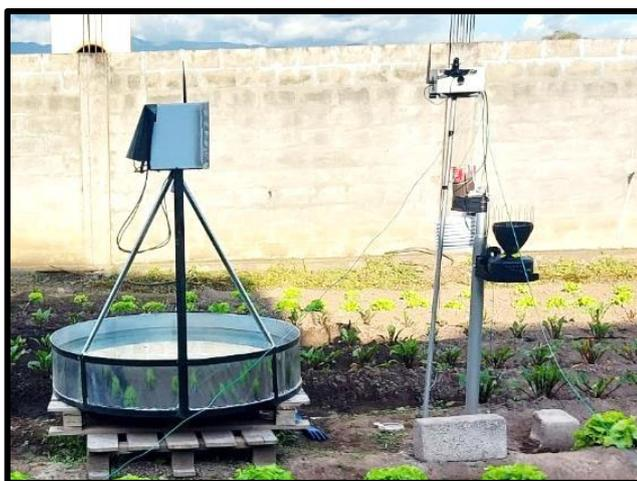
**Figura 38.** Estación meteorológica multiparámetro IoT-LoRa instalada en campo.
