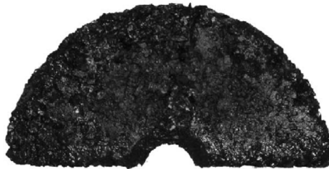
Figura 2.7 Adsorbente compuesto consolidado (carbón activado y \text{CaCl}_2 ) 39
