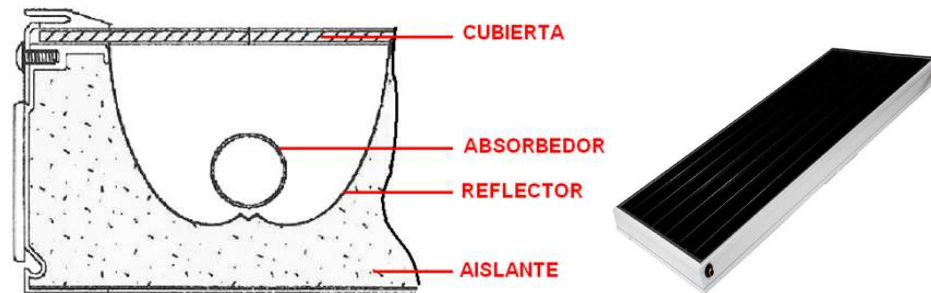
Figura 3. 6 Partes de un concentrador parabólico compuesto CPC 72
