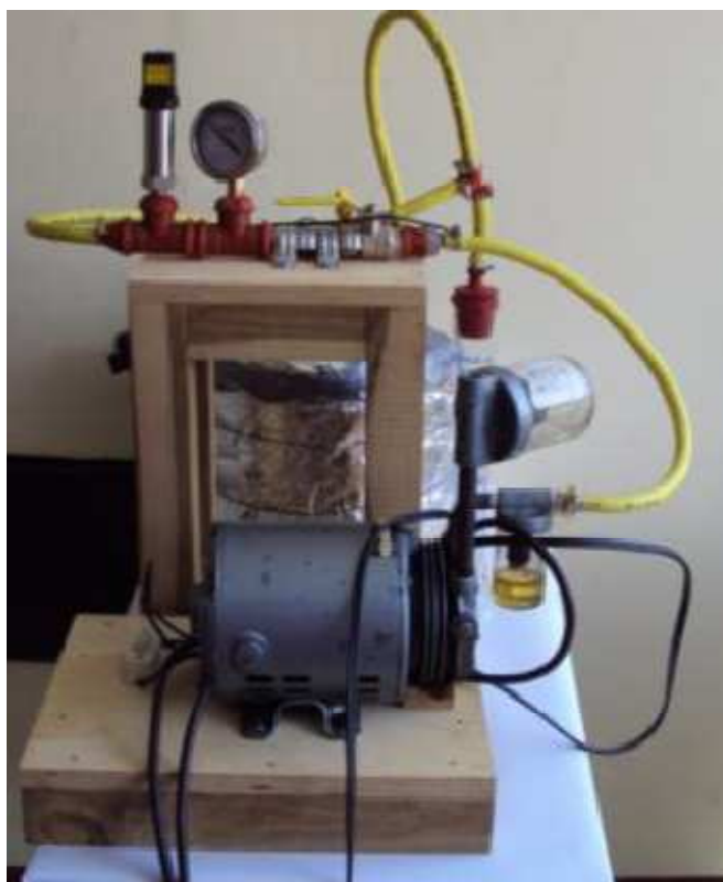
VISTA LATERAL DEL EQUIPO DE OBTENCIÓN DE ISÓSTERAS
