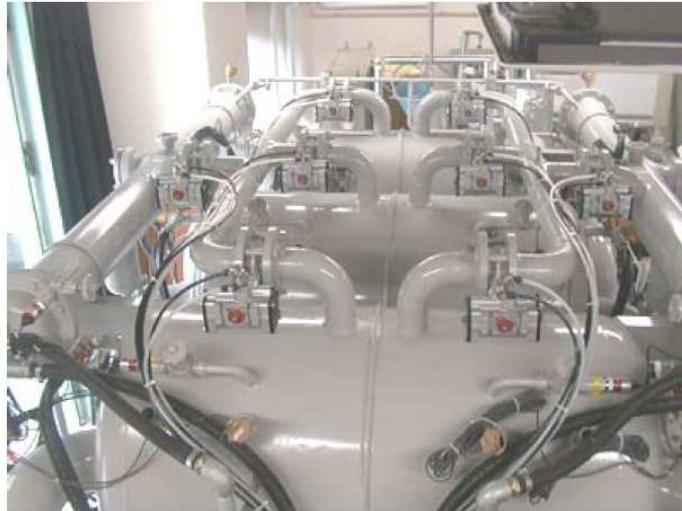
Figura 2.11 Foto de una chiller experimental de 6 camas 52
