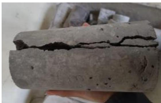
Figura 3. 8 Cilindro ensayado a tracción indirecta
