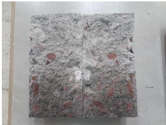
**Figura 3. 10** Penetración de agua en la probeta de hormigón
