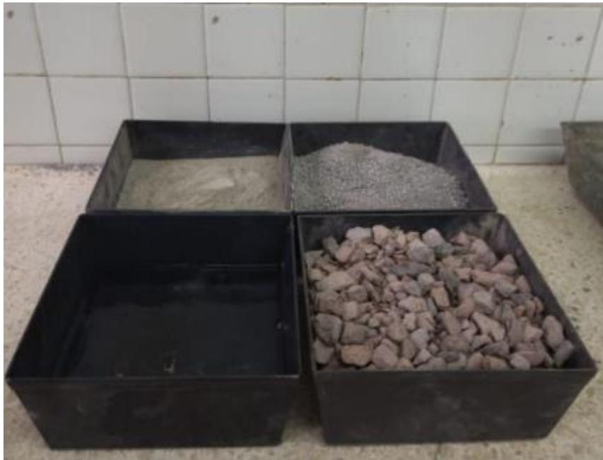
**Figura 3. 4** Dosificación para cilindros de hormigón
