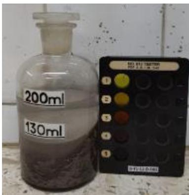
**Figura 3. 2** Ensayo de colorimetría aplicado al agregado fino
