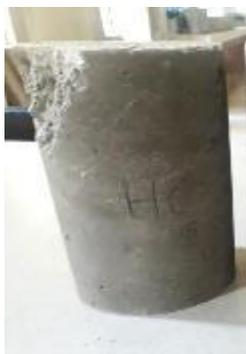
**Figura 3. 6** Cilindros de hormigón ensayados a compresión
