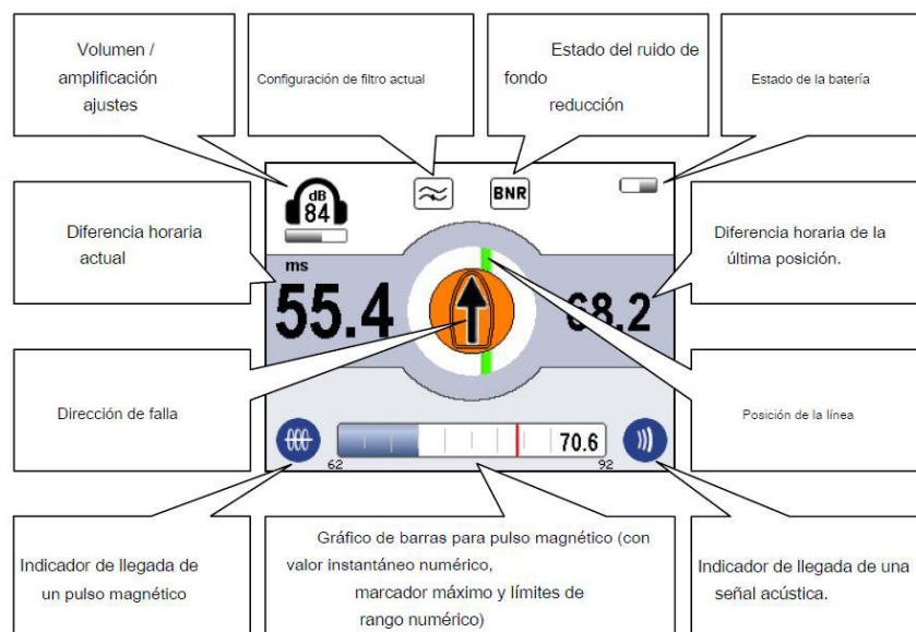
Figura 3.45. Pantalla de visualización del equipo receptor para puntualización de fallas subterráneas.
