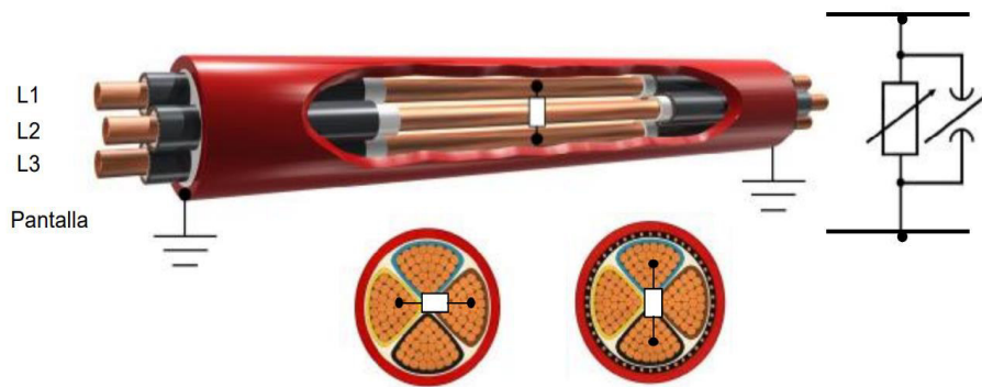
Figura 2.11. Falla en redes subterránea de cortocircuito
