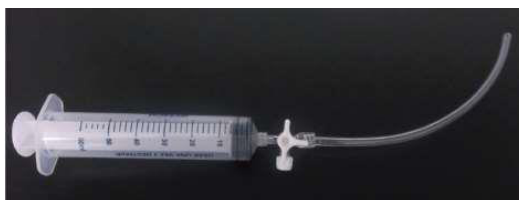
Figura 3.14. Jeringa para la extracción de aceite para análisis de contenido de PCB's
