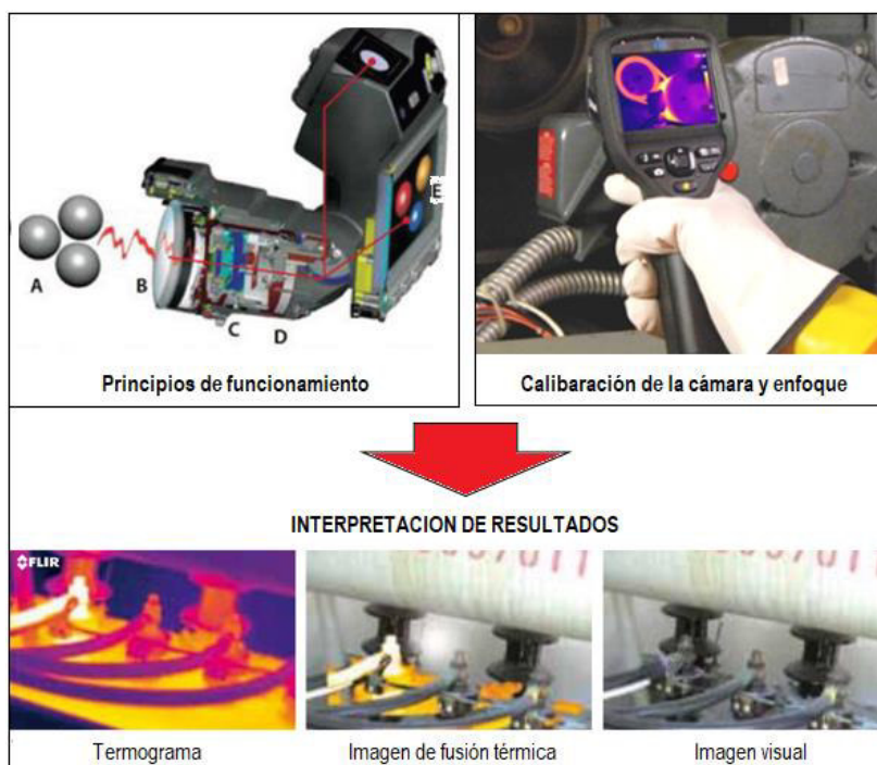
Figura 2.47. Funcionamiento cámara termográfica.
