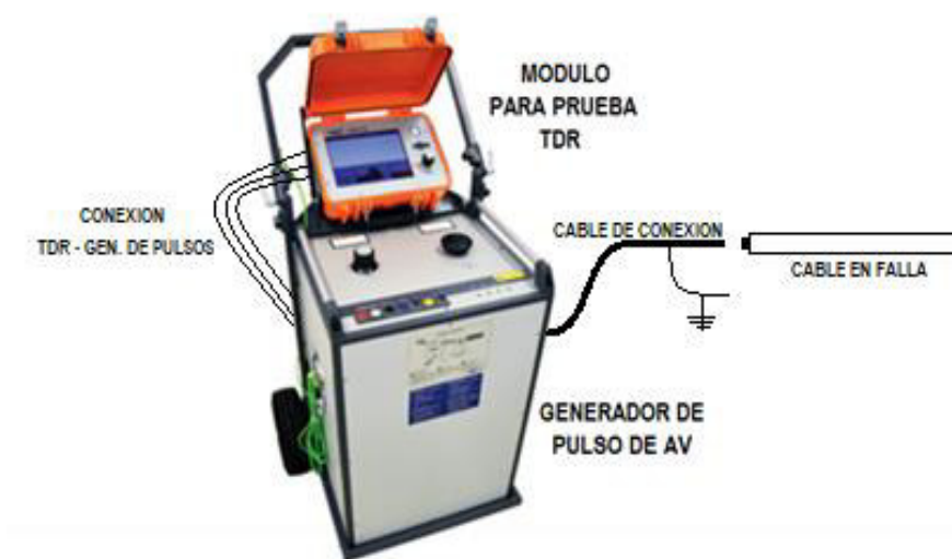
Figura 3.34. Equipo necesario para prueba de reflexión de arco (ARM). Marca Megger
