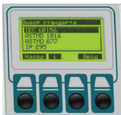
Figura 3.12. Panel de control equipo medidor de rigidez eléctrica del aceite. Marca KEP
