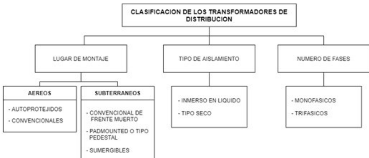
Figura 1.11. Clasificación de los transformadores de distribución
