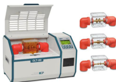
Figura 3.11. Equipo OLT-80 para prueba de rigidez dieléctrica de aceite. Marca KEP.
