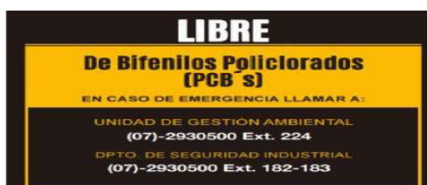
Figura 3.16. Etiqueta informativa sobre la presencia de PCB's. Norma NTE INEN 2266:2013
