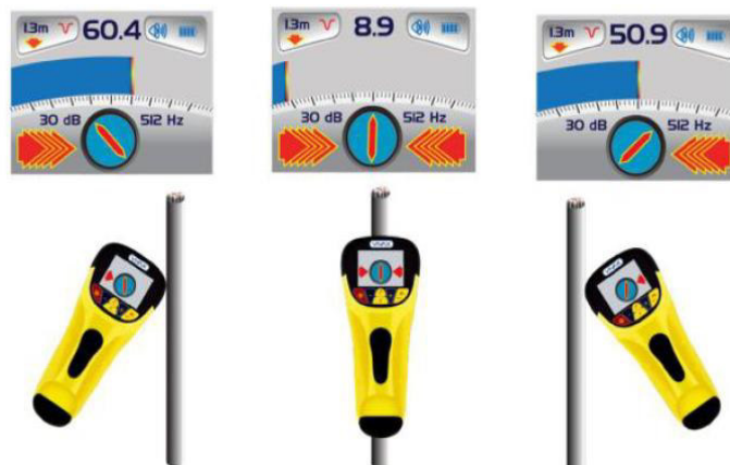
Figura 3.42. Información de trazabilidad de un cable subterráneo a través del equipo receptor.
