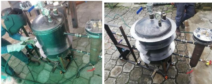
Figura 2.53. Montaje del calderín parte 2
