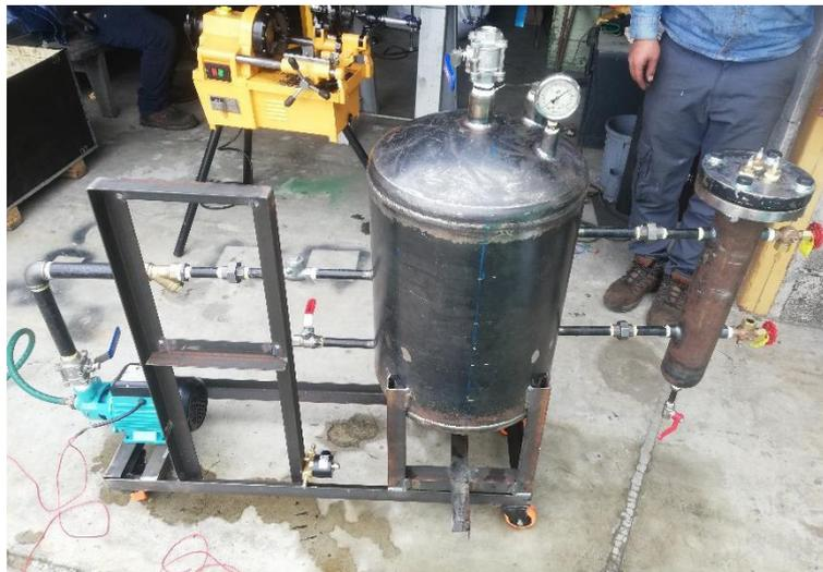
Figura 2.58. Prueba hidrostática.
