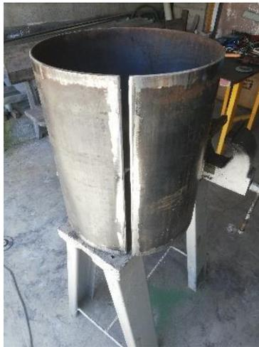
Figura 2.44. Cuerpo cilíndrico
