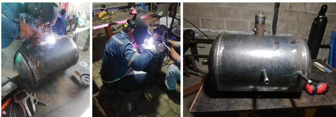
Figura 2.46. Construcción del recipiente a presión
