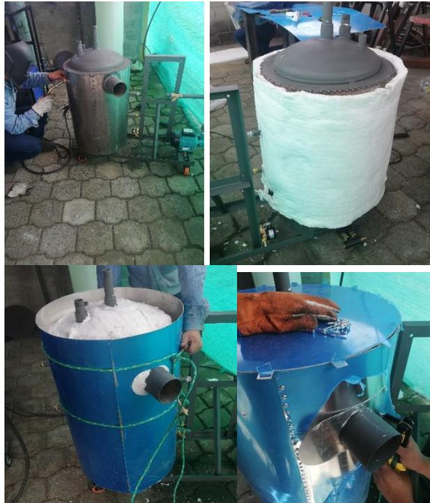
Figura 2.54. Montaje del calderín parte 3.
