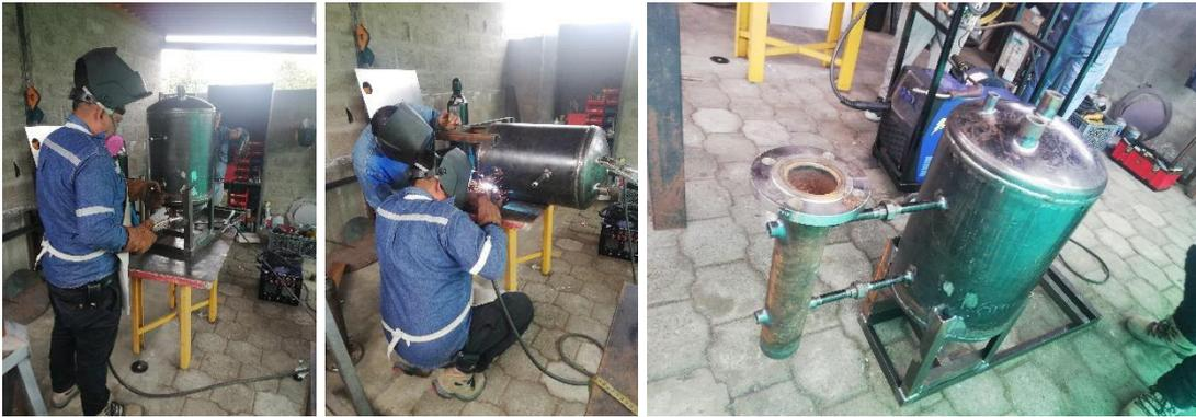
Figura 2.52. Montaje del calderín parte 1.
