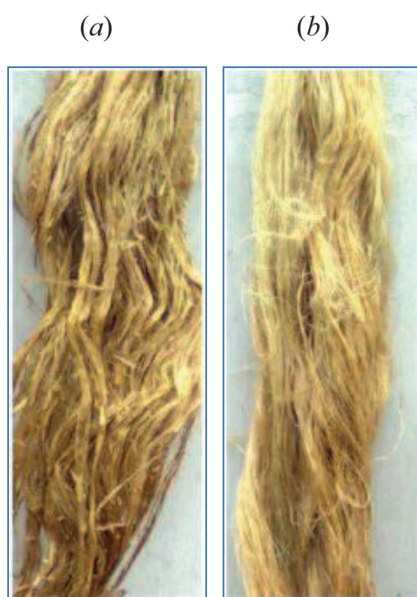
Figura 1.9. Fibra de ramio (a) antes de peinar (b) después de peinar
