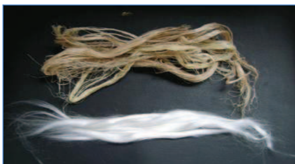
Figura 1.10. Fibra de ramio cruda y desgomada
