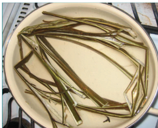
Figura 3.12. Disposición de los tallos de la fibra de ramio durante la extracción en agua caliente
