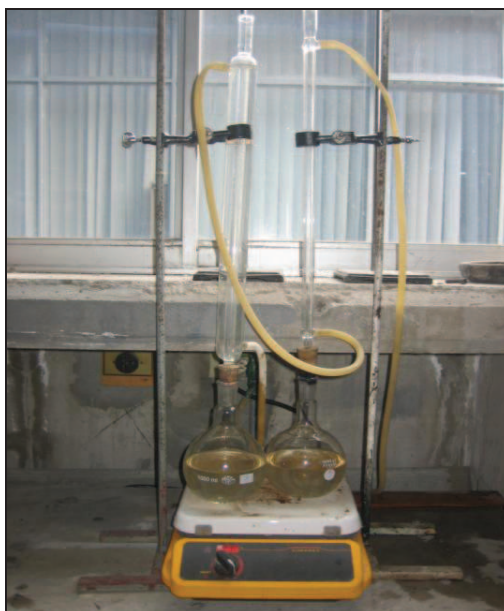
Figura 2.9. Equipo de reflujo armado
