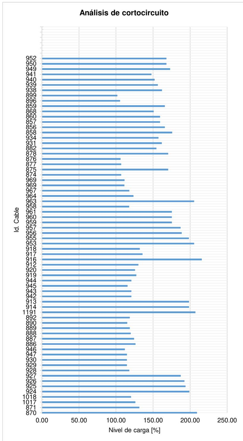
**Figura 3.7.** Nivel de carga de cables en caso de falla [elaboración propia].
