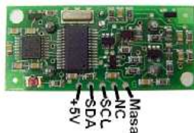
Fig. 1.16 conexiones del SRF08 [4]
