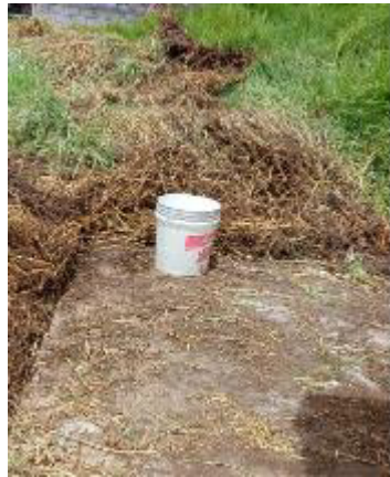
Figura 3. Toma de muestra de agua lluvia en baldes
