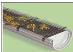
Figura 1. Rejilla para remoción de sólidos
