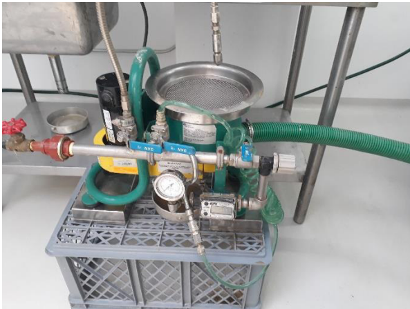
Figura AV.1. Concentrador centrífugo KC-MD3 disponible en el Laboratorio de Metalurgia del IIGE.
