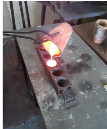
Figura AVI.2. Colado de la muestra fundida.
