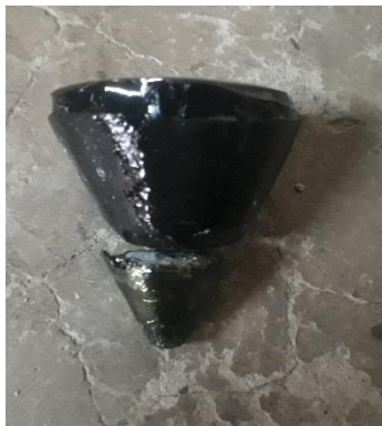
Figura AVI.3. Fase escoria y metálica.
