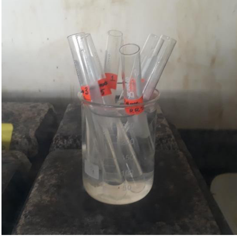
Figura AVII.1. Disgregación de plata con 1 mL de ácido nítrico y 1 mL de agua en baño maría.
