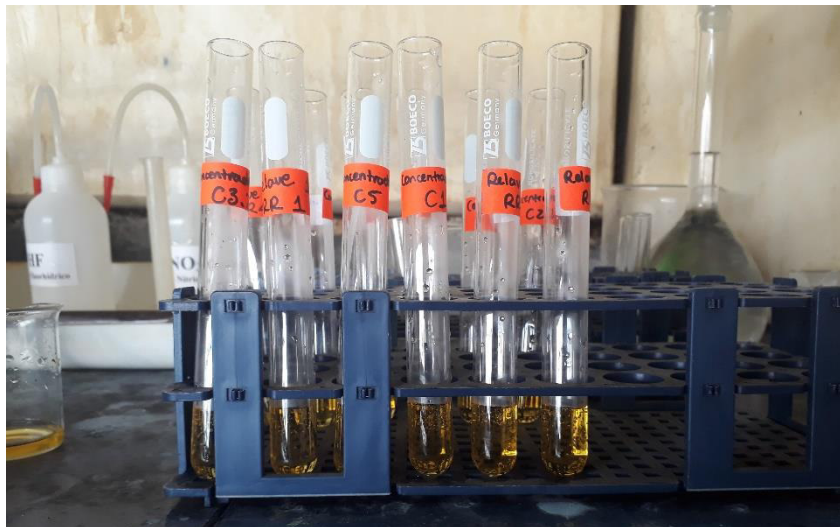
Figura AVII.3. Adición de 3 mL de agua regia para la disgregación del oro.
