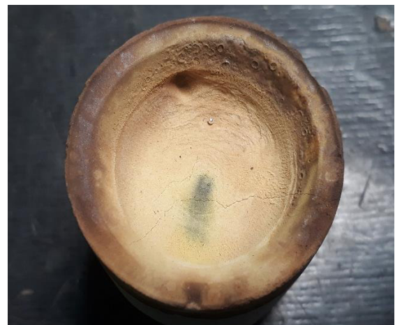
Figura AVI.6. Doré obtenido luego de la copelación.
