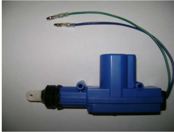
Fotografía 2.13 Motor DC de desplazamiento lineal.
