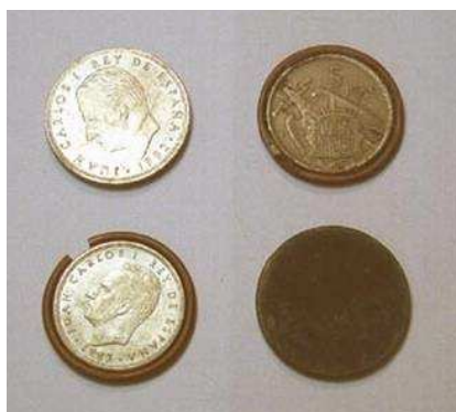
Fotografía 1.13 De arriba a abajo y de izquierda a derecha, moneda de 25 pts. dos monedas de 5 pts. "manipuladas" y una chapa de latón de medidas equivalentes.
