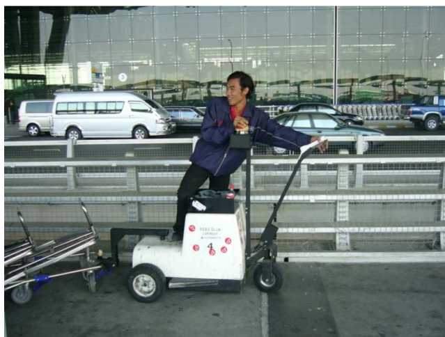
Fotografía 1.3 Carro Mula en el Aeropuerto Internacional de Suvarnabhumi, Tailandia - un vehículo eléctrico para recoger coches de equipaje.
