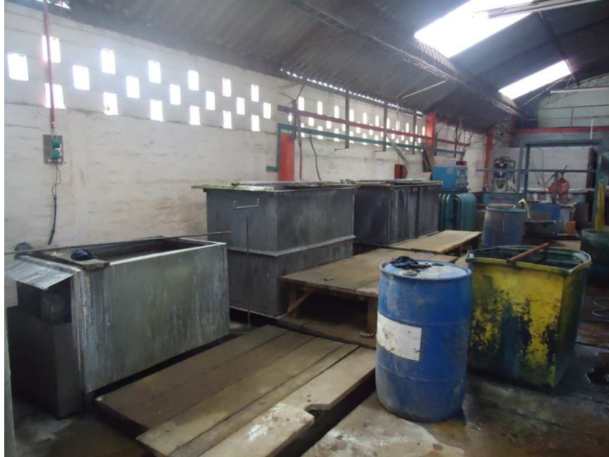
Fotografía 4.2 Tanques de limpieza antes del proceso de Cromado.
