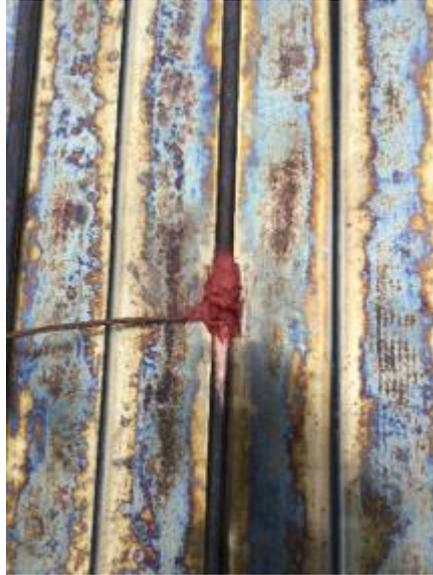
**Figura 14.** Termocupla colocada en el absorbedor (Fuente: Propia).
