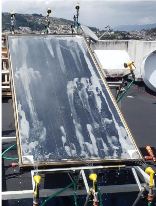
**Figura 36.** Evidencia fotográfica del colector posterior al ensayo de choque térmico externo (Fuente: Propia).
