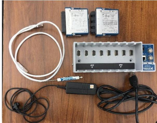
**Figura 24.** Chasis CDAQ montado en el banco de pruebas (Fuente: Propia).
