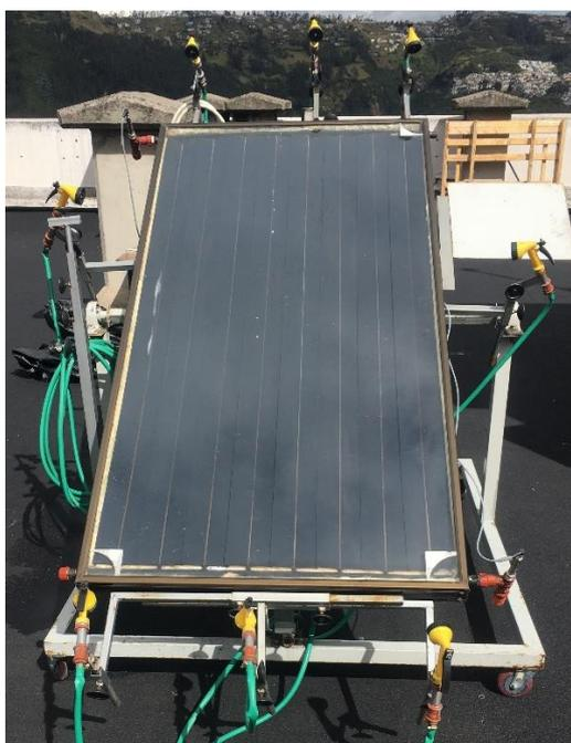
**Figura 35.** Evidencia fotográfica del colector posterior al ensayo de la temperatura de estancamiento (Fuente: Propia).
