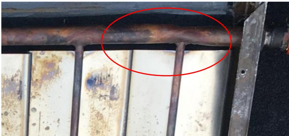
**Figura 37.** Evidencia fotográfica del colector posterior al ensayo de choque térmico externo (Fuente: Propia).
