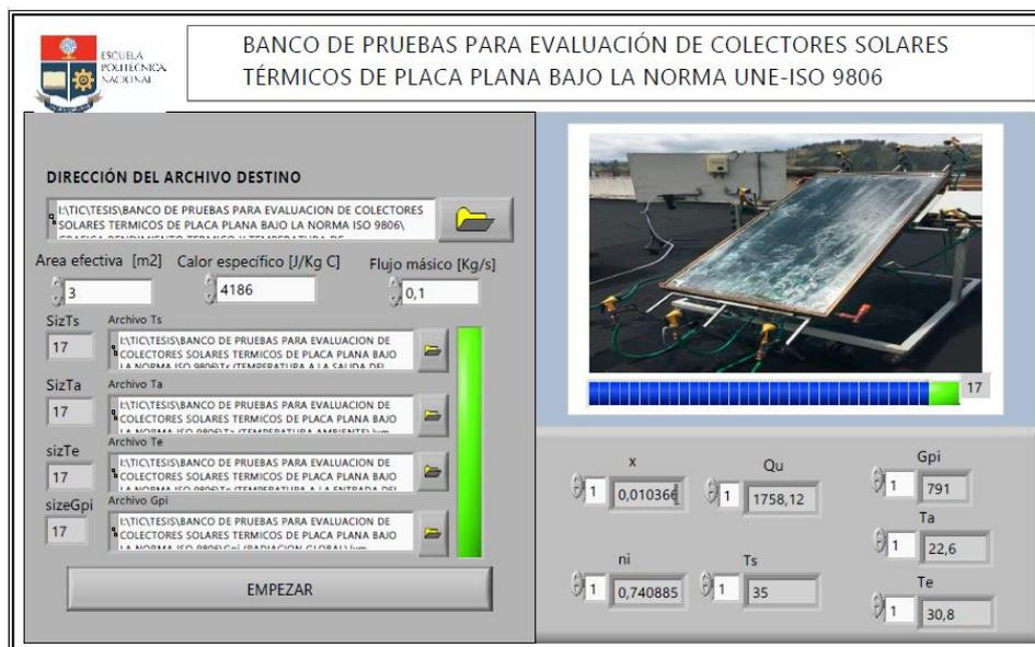
**Figura 31.** Funcionamiento del HMI programado para la obtención de la gráfica de rendimiento térmico y la temperatura de estancamiento (Fuente: Propia).
