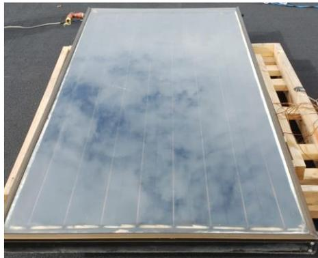
**Figura 15.** Colector ensamblado con la termocupla en el absorbedor (Fuente: Propia).
