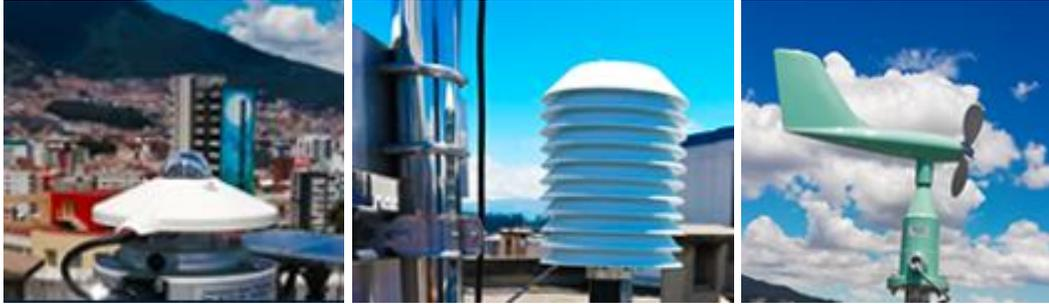
**Figura 9.** De izquierda a derecha -Piranómetro, Sensor de temperatura ambiente y anemómetro (Fuente: SCINERGY,2022) [19].
