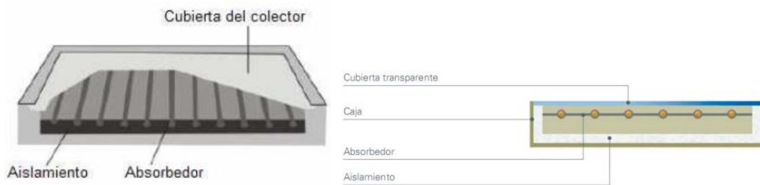
**Figura 1.** Partes del colector solar de placas planas (Fuente: INEN 2507) [9].
