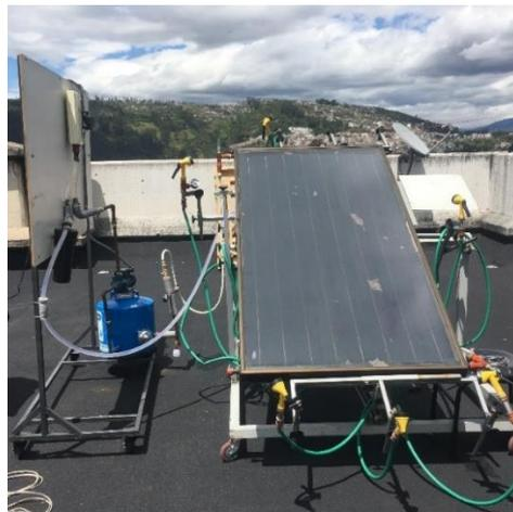
**Figura 5.** Banco de Pruebas instalado y verificado su funcionamiento (Fuente: Propia).
