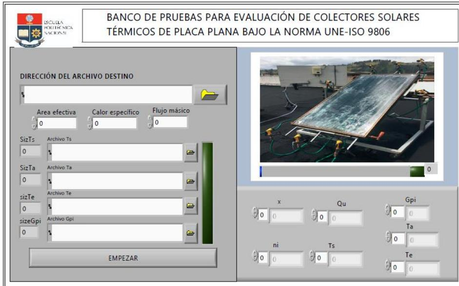
**Figura 30.** Ventana de controladores del HMI programado para la obtención de la gráfica de rendimiento térmico y la temperatura de estancamiento (Fuente: Propia).
