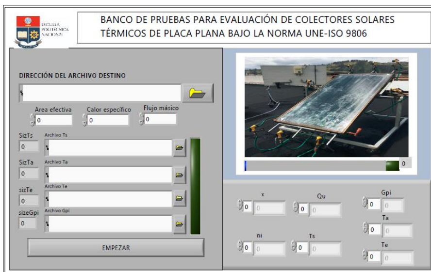
Figura 28. HMI del programa 2 encargado de obtener la gráfica de rendimiento térmico y la temperatura de estancamiento (Fuente: Propia).
