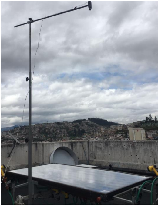
Figura 38. Montaje del colector sobre la estructura para el ensayo de impacto (Fuente: Propia).
