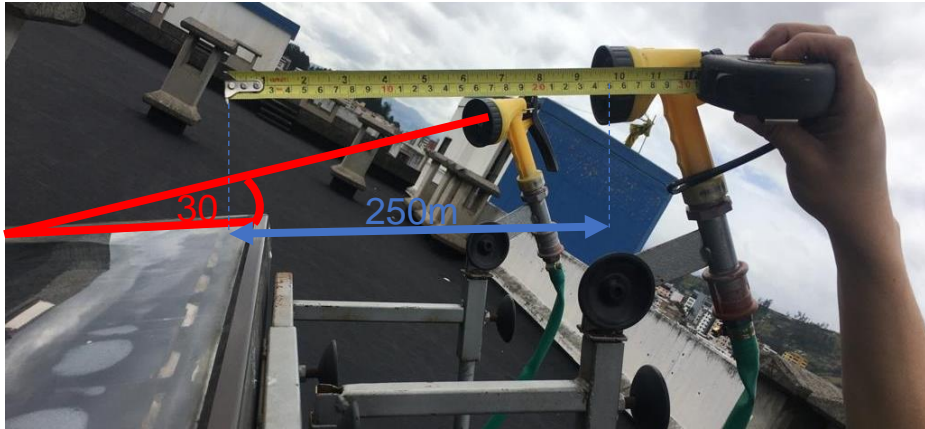
Figura 30. Ángulo de inclinación de las boquillas y distancia de separación (Fuente: Propia).
