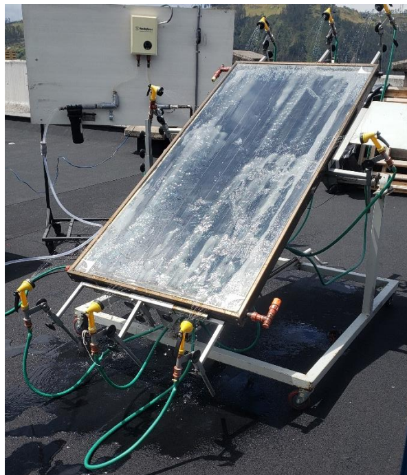
Figura 32. Ejecución del ensayo de penetración de lluvia (Fuente: Propia).
