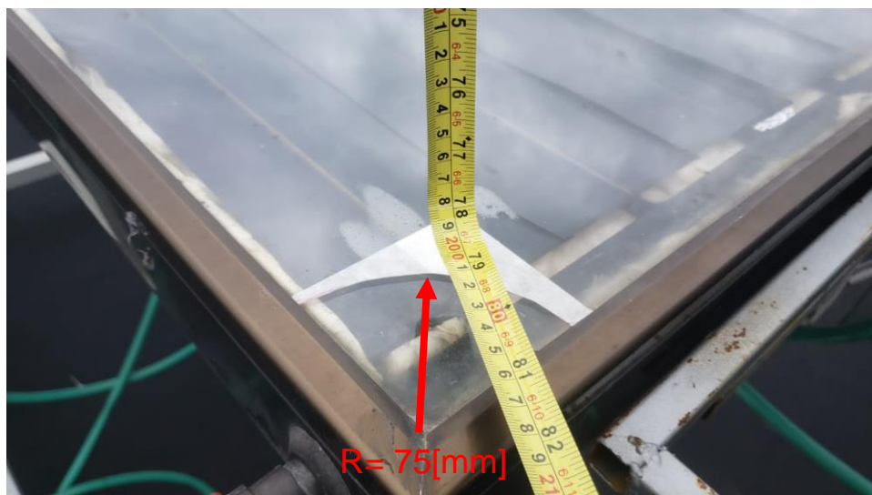
Figura 37. Área de impacto en el colector ensayado (Fuente: Propia).
