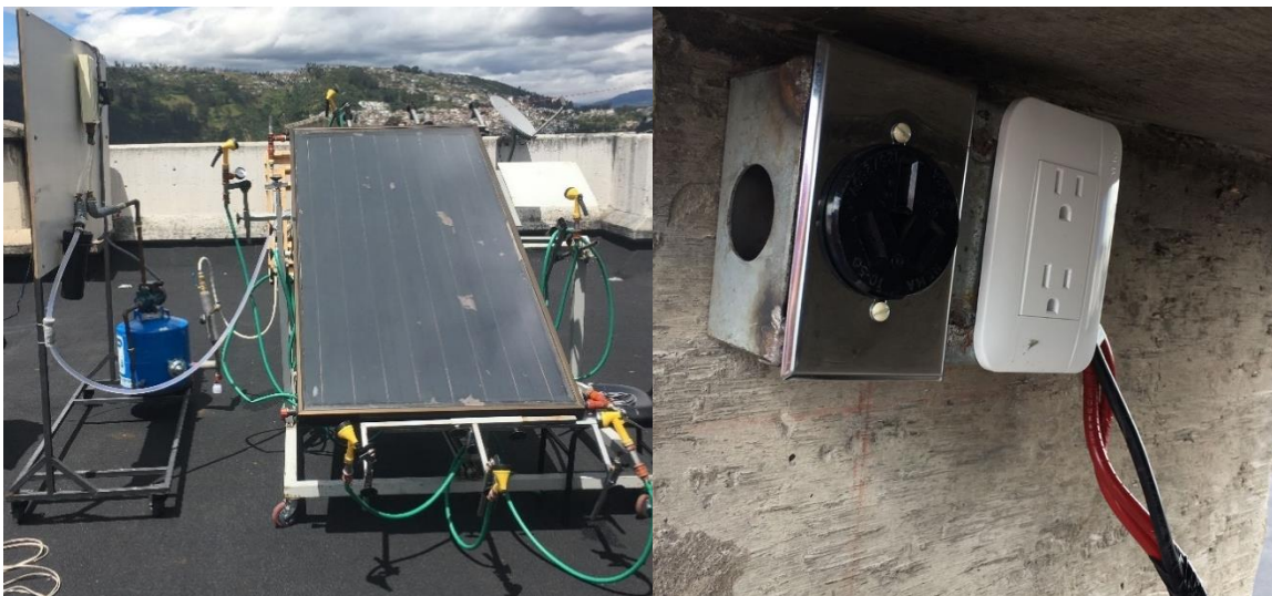
Figura 14. Izq. Banco de pruebas operativo, Dcha. Tomacorrientes 100 y 220 [V AC ] (Fuente: Propia).
