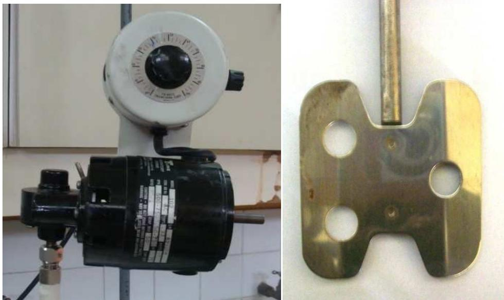
**Figura 12.** Motor de agitación y agitador tipo ancla empleados en las pruebas a escala de laboratorio
