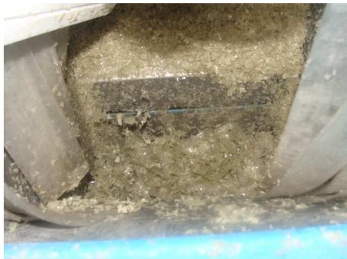
**Figura 31.** Parte interna del molino de cuchillas en la etapa de reducción de tamaño. (Servicios Técnicos Industriales)
