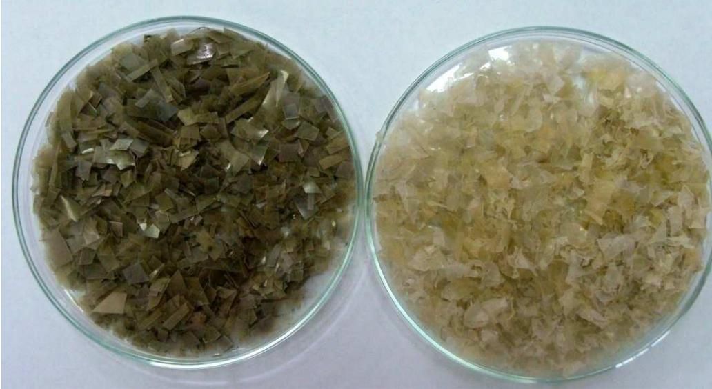
**Figura 77.** Comparación entre la muestra inicial (sin ningún proceso) y la muestra lavada a mayor escala.
