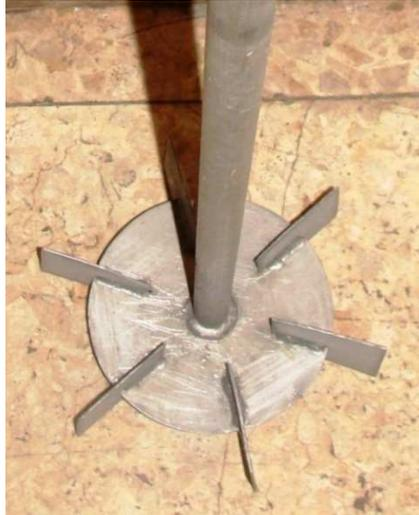
**Figura 25.** Agitador mecánico de seis paletas empleado en las pruebas de lavado a mayor escala.
