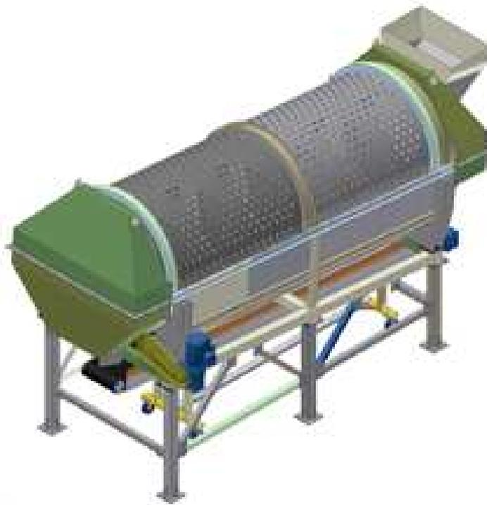
**Figura 5.** Esquema de un tromel de lavado.
