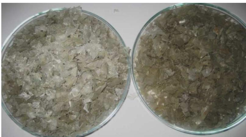
**Figura 45.** Comparación de los plásticos antes y después del primer enjuague al emplear el sistema agua-NaOH
