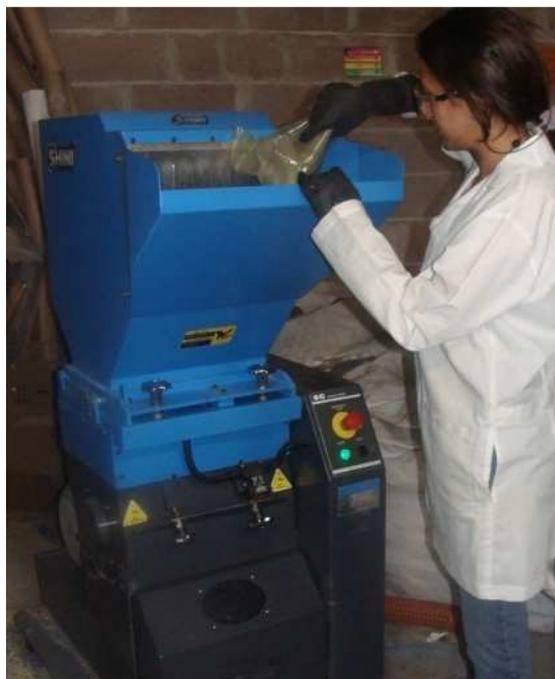
**Figura 22.** Molino de cuchillas empleado para la reducción de tamaño del plástico
