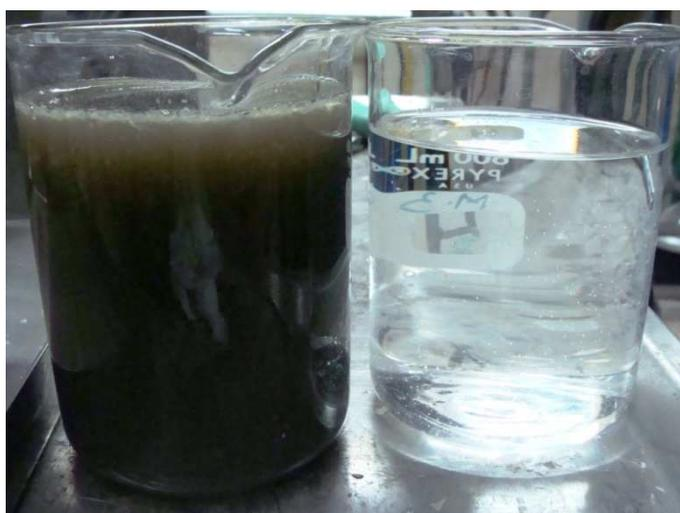
**Figura 80.** Agua de lavado comparada con agua limpia al realizar 3 cargas de material al emplear la misma agua de lavado para un tiempo de 20 min.
