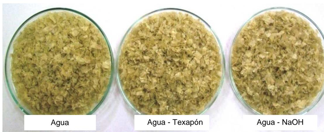
**Figura 65.** Plásticos empleando los tres sistemas de lavado, empleando un tiempo de lavado de 25 min.
