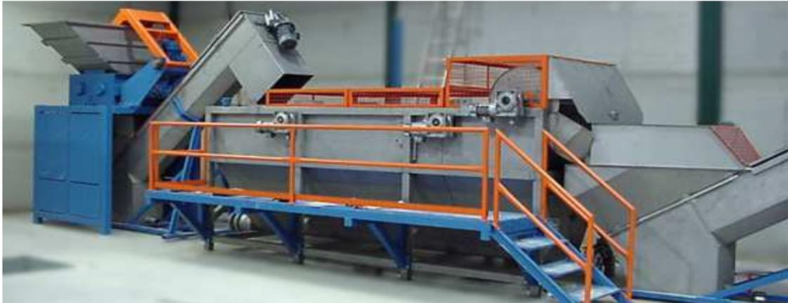
**Figura 3.** Línea de reciclaje compuesta por una etapa de pre-trituración, y una etapa de pre-lavado con agitación en una balsa de lavado y decantación.
