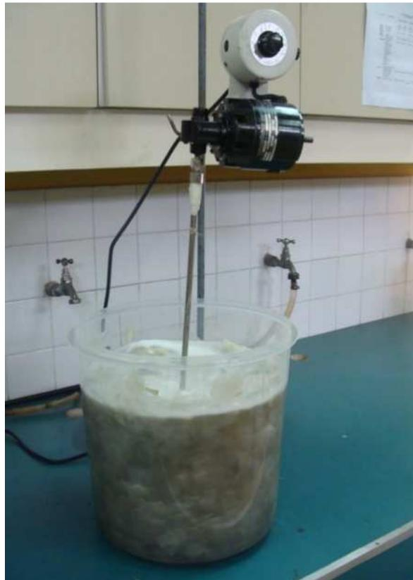
**Figura 19.** Foto del equipo de lavado usado a escala de laboratorio.
