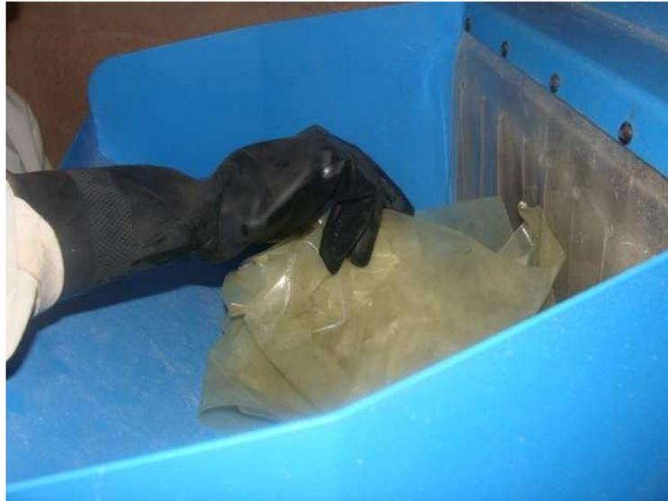
**Figura 30.** Alimentación del plástico prelavado al molino de cuchillas. (Servicios Técnicos Industriales)
