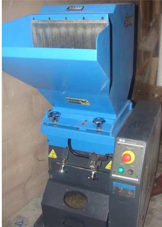
**Figura 14.** Molino de cuchillas SHINI. (Servicios Técnicos Industriales)
