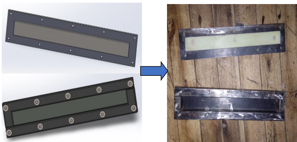
Figura 2.4 Modelado en SolidWorks y obtención final de molde fabricado
