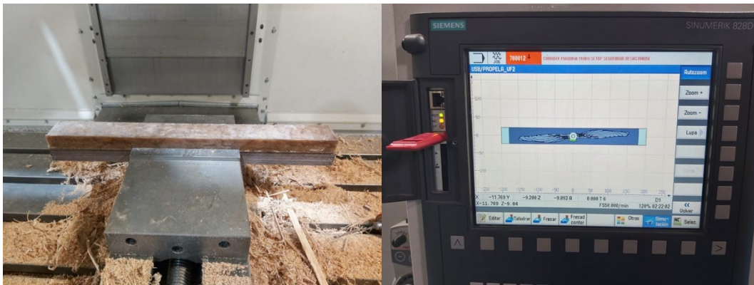
Figura 2.19 Proceso de mecanizado de lingote de material compuesto
