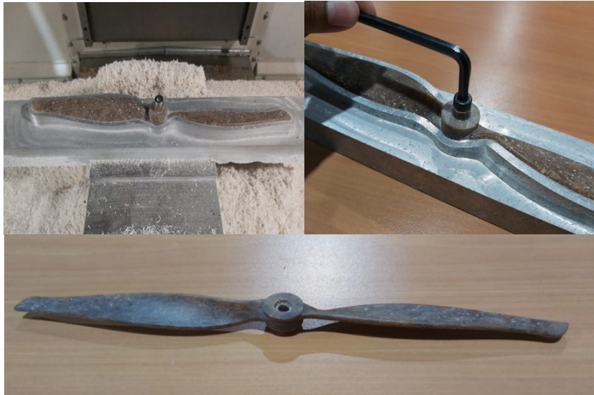
Figura 2.23 Obtención de propela de matriz poliéster reforzada con fibra de yute
