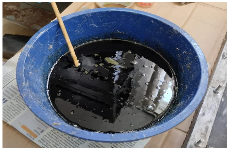
Figura 2.9 Mezcla de solución con MEKP
