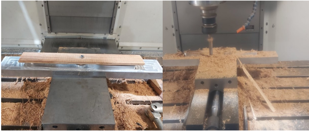
Figura 5.3 Mecanizado de segunda cara de propela de madera
