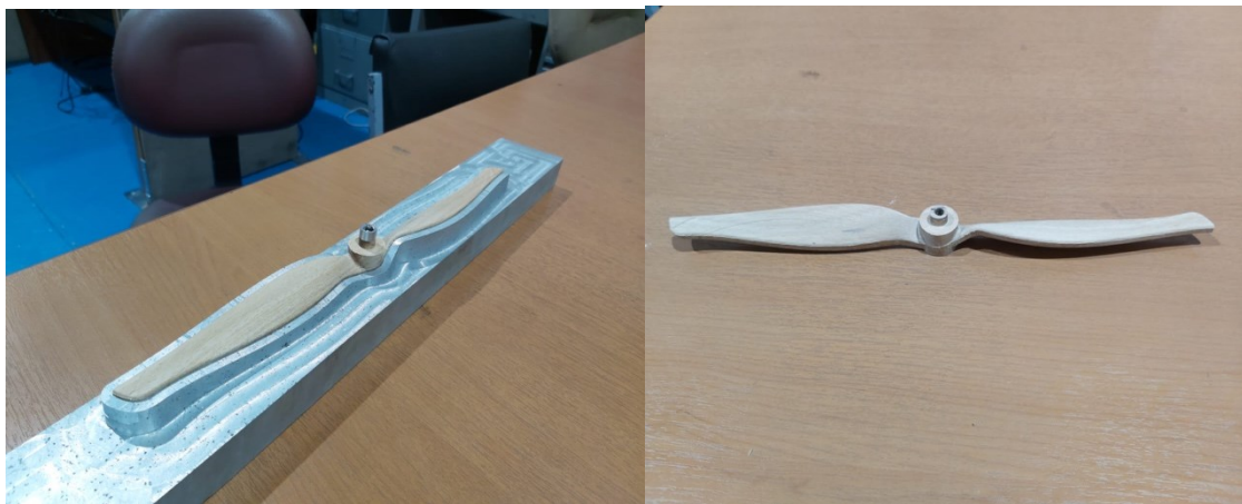
Figura 5.4 Obtención final de prueba de mecanizado de propela en madera
