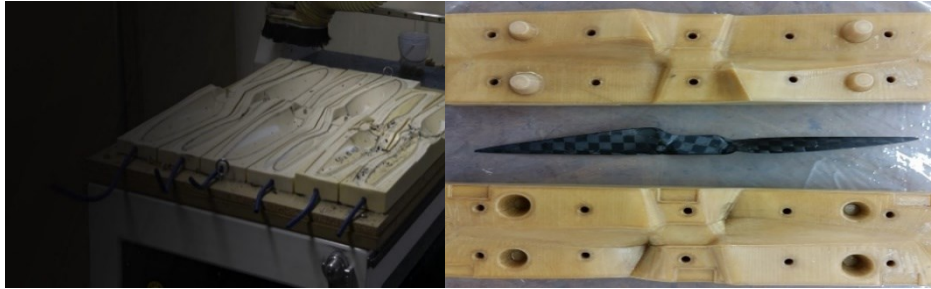
Figura 1.15 Fabricación de propela por compresión
