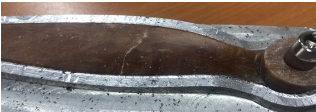
Figura 5.6 Falla de propela de material compuesto
