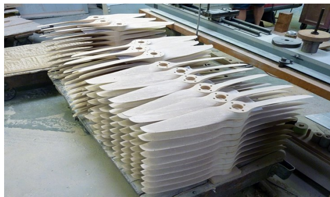
Figura 1.12 Maquinado manual de una propela de dos aspas
