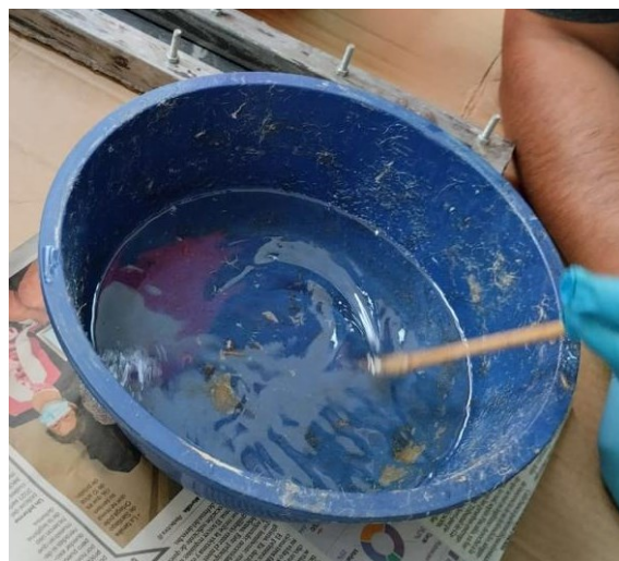
Figura 2.7 Mezcla de resina con estireno (Fuente: Propia)
