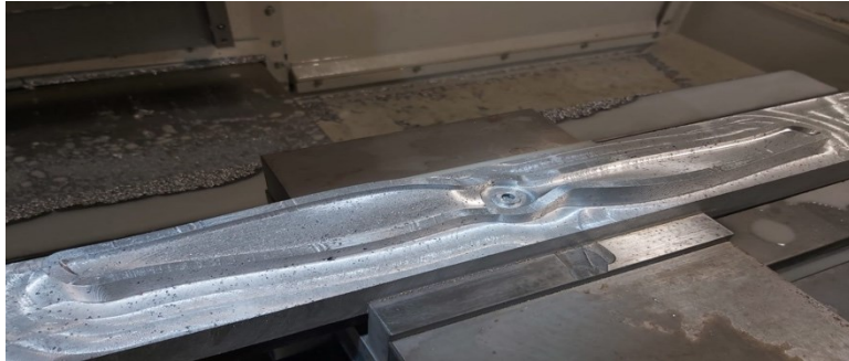
Figura 2.16 Molde final de aluminio: base de la propela
