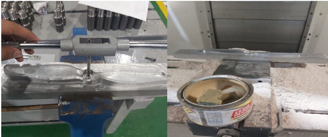
Figura 2.21 Preparación de molde de aluminio de propela
