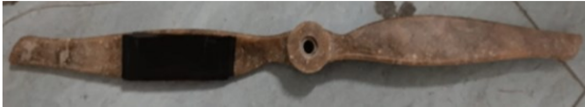
Figura 2.25 Balanceo de propela de material compuesto con cinta adhesiva (Taípe) (Fuente: Propia)
