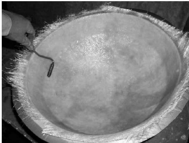
Figura 1.5 Proceso hand lay up
