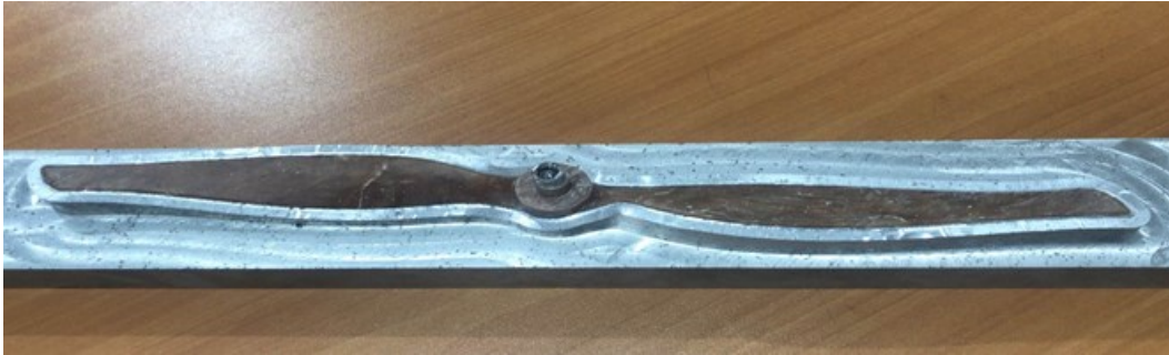
Figura 5.5 Propela fallida durante el primer intento de mecanizado
