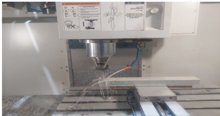
Figura 2.14 Proceso de desbastado de lingote de aluminio
