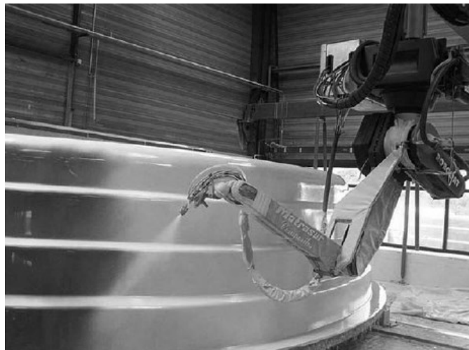
Figura 1.6 Proceso de moldeo por aspersión
