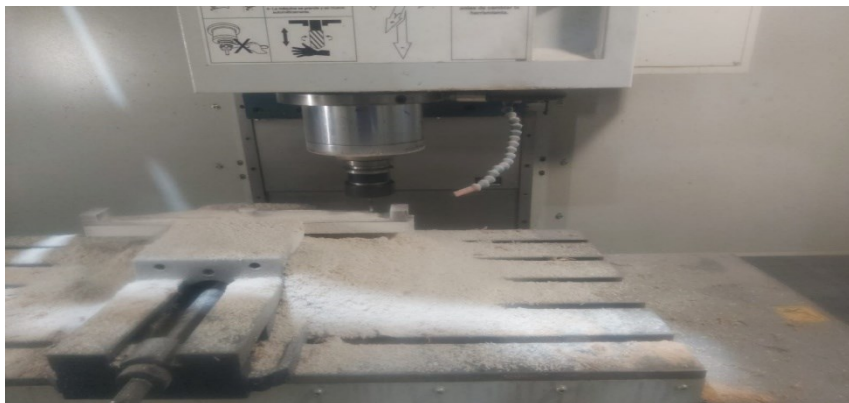
Figura 2.20 Mecanizado de primera cara de propela de material compuesto
