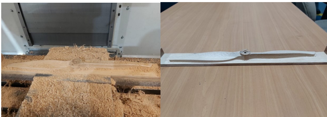
Figura 5.2 Mecanizado de la primera cara de la propela de madera
