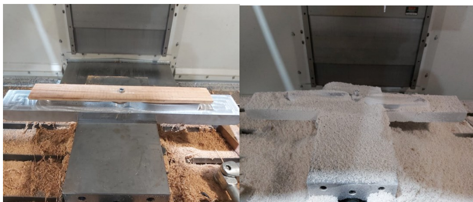
Figura 2.22 Proceso de mecanizado de segunda cara de propela
