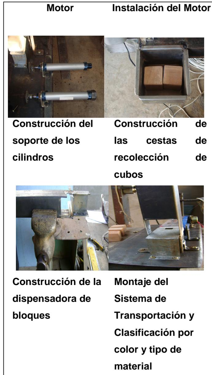
**Figura 41:** Elementos Metal/Mecánicos
