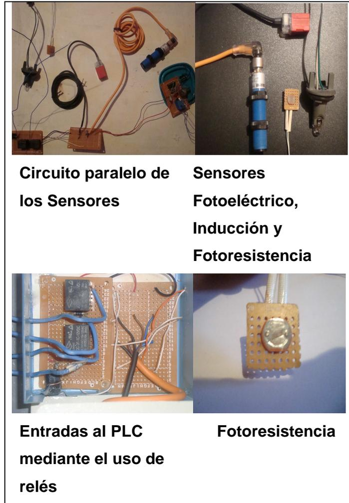
**Figura 42:** Foto-resistencia, Sensor Fotoeléctrico e Inducción
