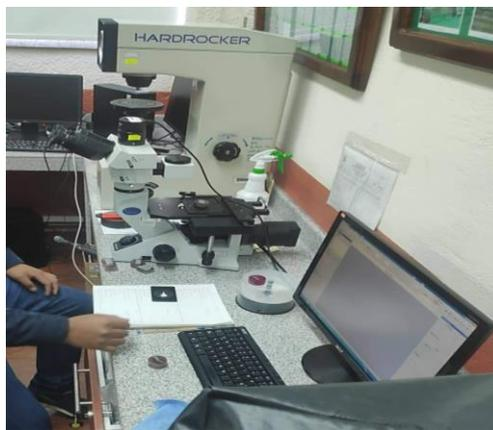
**Figura 2.5.7.** Microscopio óptico Olympus GX41.
