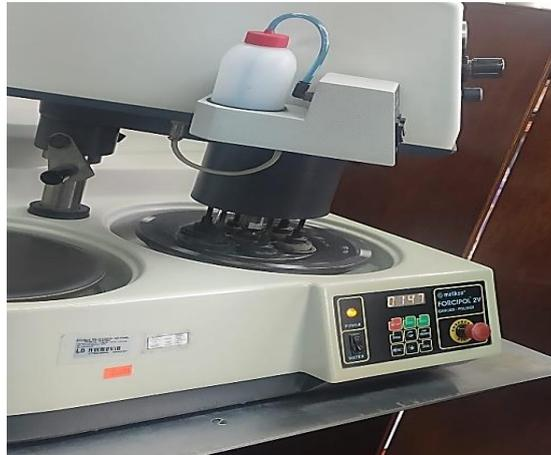
**Figura 2.5.4.** Proceso de lijado mediante la máquina automática Forcipol 2V con cabezal Forcimat.
