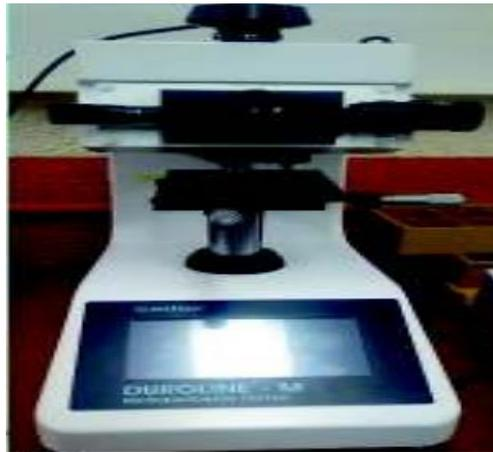
**Figura 2.5.10.** Equipo DUROLINE-M para el ensayo de microdureza Vickers.
