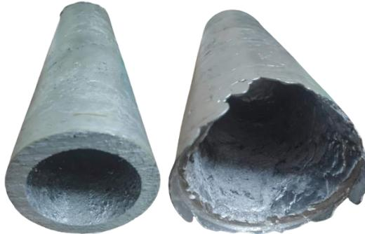
**Figura 3.1.1.** Tubo FGM con refuerzo de partículas de SiC malla #320.
