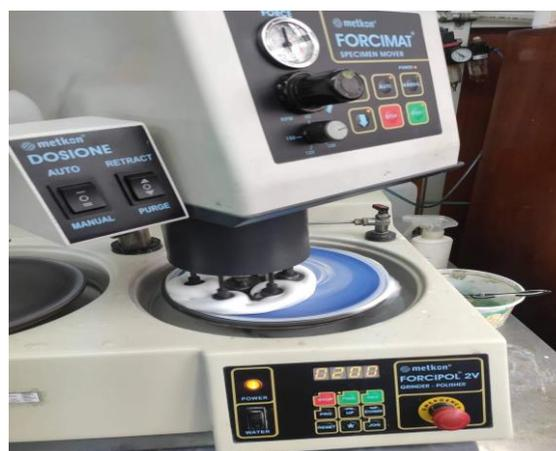
**Figura 2.5.5.** Proceso de pulido mediante la máquina automática Forcipol 2V con cabezal Forcimat.
