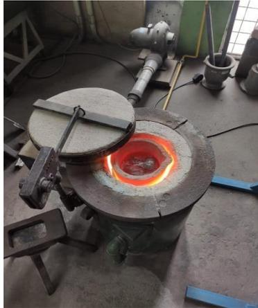
**Figura 2.4.2.** Proceso de fundición de aluminio.
