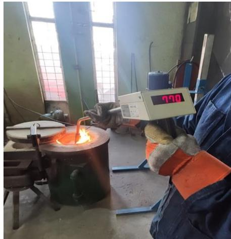
**Figura 2.2.6.** Termocupla del laboratorio de Fundición EPN.
