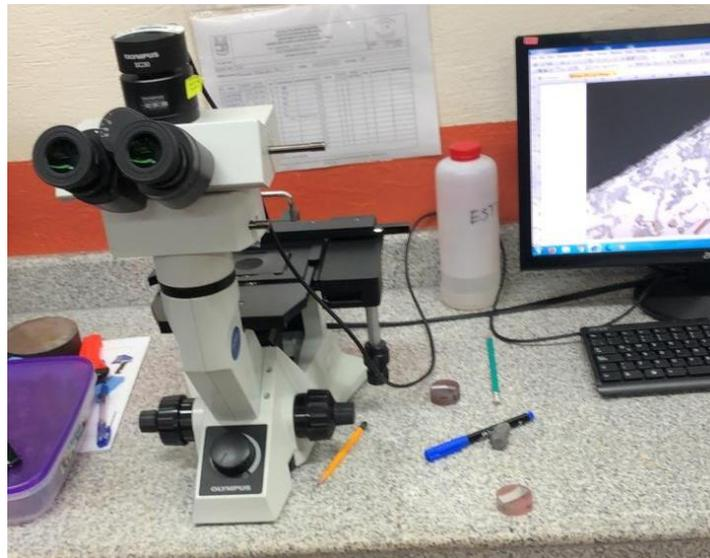
**Figura 2.5.9.** Visualización de la microestructura de las probetas ataque químico.
