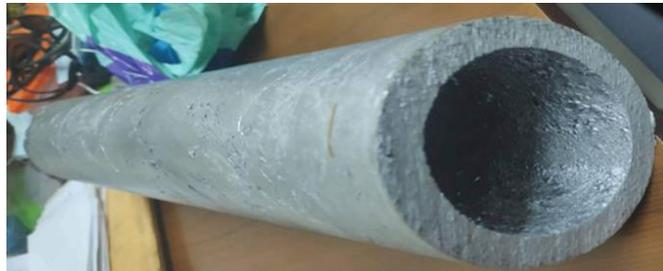
Figura 2.4.6. Tubo de FGM con partículas de SiC.
