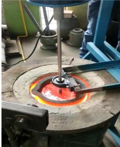
**Figura 2.4.4.** Proceso de mezclado con la máquina Stir Casting.
