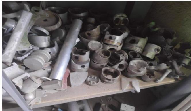
**Figura 2.2.7.** Pistones de aluminio para la fundición de la matriz.
