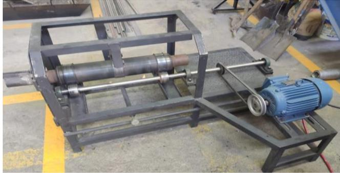
**Figura 2.2.3.** Máquina de colado centrífugo horizontal Laboratorio de fundición EPN.
