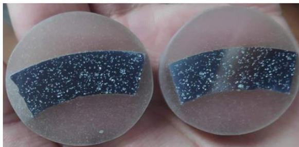
**Figura 3.1.2.** Porosidades en la sección transversal del tubo de FGM.
