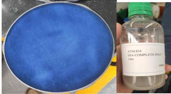
**Figura 2.5.6.** Paño de pulido y suspensión de diamante de 1  $\mu\text{m}$ .
