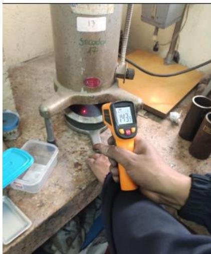
**Figura 2.4.3.** Proceso de secado de las partículas de SiC.
