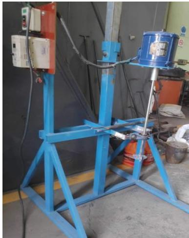
**Figura 2.2.2.** Maquina Stir Casting del Laboratorio de fundición EPN.
