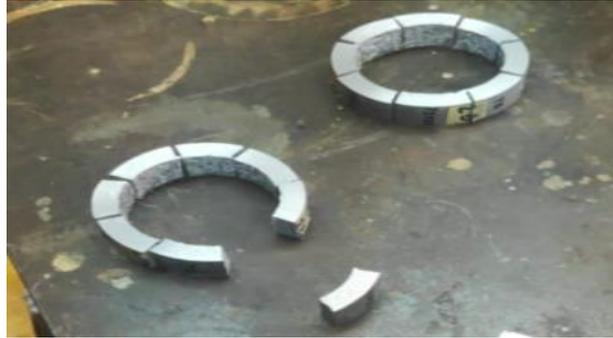
**Figura 2.5.2.** Probetas del FGM con partículas de SiC.
