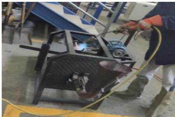
**Figura 2.4.5.** Proceso de centrifugado para la formación de un FGM.
