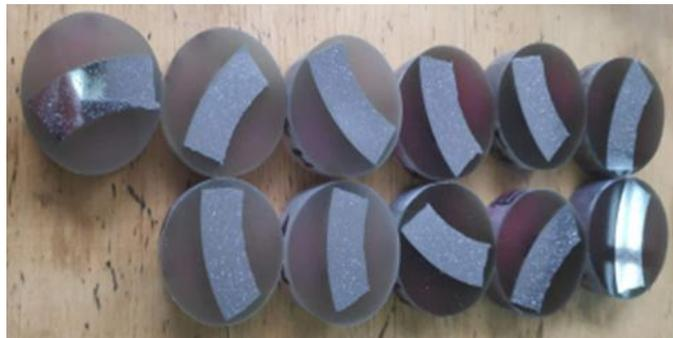
**Figura 2.5.3.** Empastillado de las probetas.
