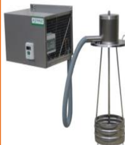
Figura 8. Refrigerador de inmersión HM.
