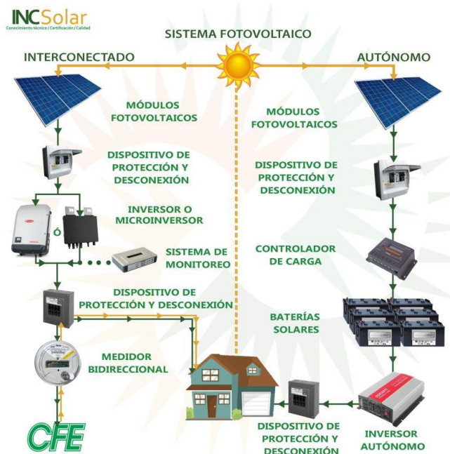
Figura 3. Sistema fotovoltaico interconectado a la red y asilado.
