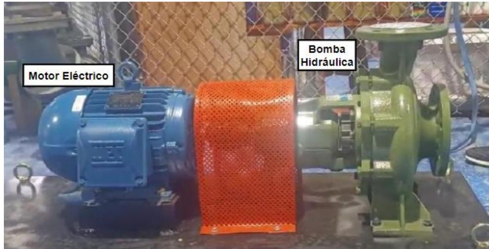
Figura 2.2. Bomba centrífuga acoplada al moto eléctrico.
