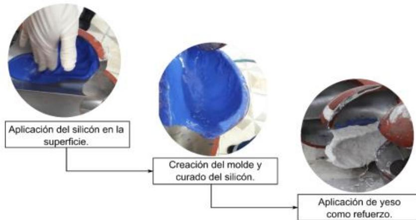
Figura 1.2. Obtención molde de silicón de un cangilón turbina Pelton.
