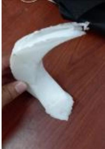
*Figura 2.4. Cavidad interna Impeler de caucho de silicón.
