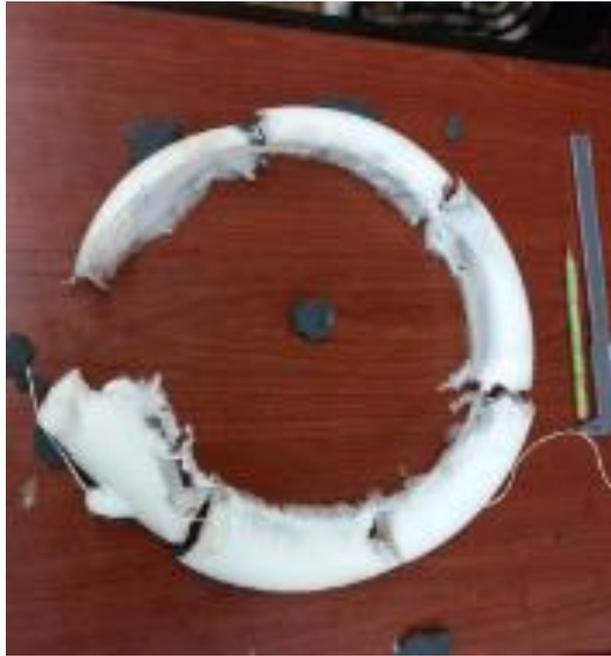
*Figura 2.3. Parte interna Voluta, Caucho de Silicon.*
