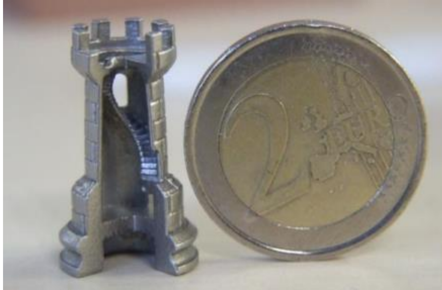
Figura 7. Tamaño y geometría de un elemento sólido realizado por medio de impresión 3D.
