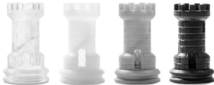
Figura 8. Elementos creados con tecnología de estereolitografía. Fuente: 3Dnatives
