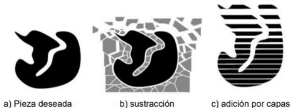
Figura 6. fabricación sustractiva comparando con Manufactura aditiva. Fuente:[14]
