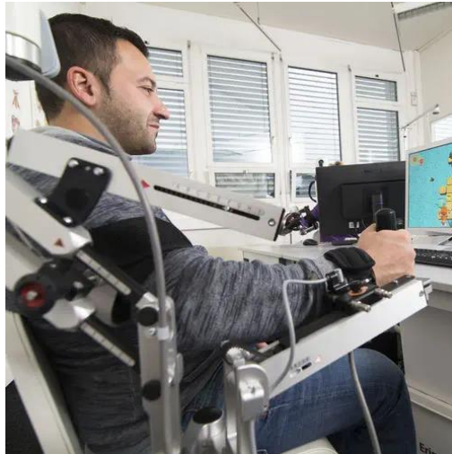
Figura 4. Sistema de rehabilitación brazo (Armeo Spring y Manovo Spring Hand Module).
