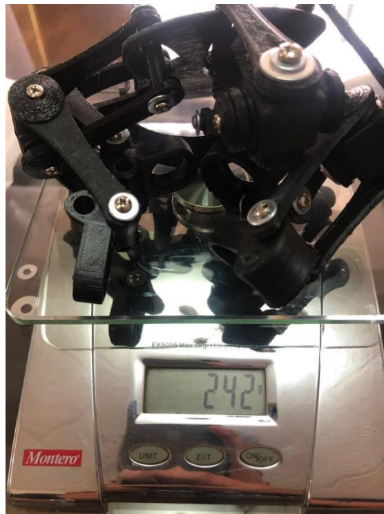
Figura 39. Masa Ortesis ensamblada. Fuente: Propia
