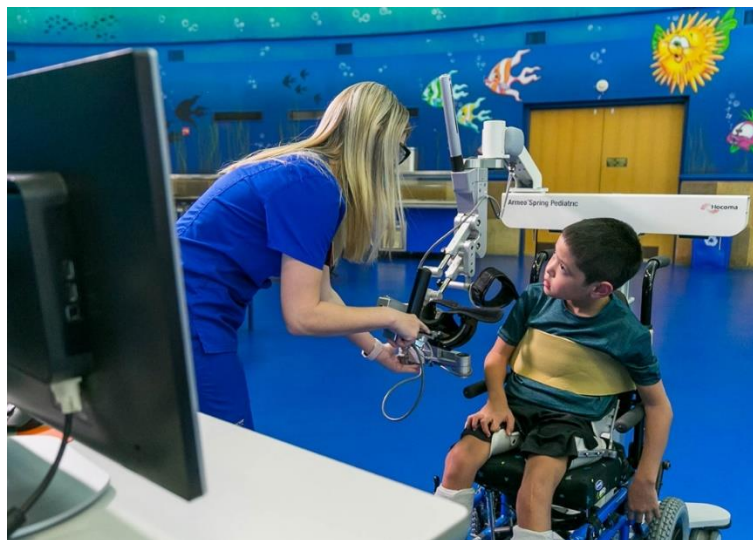
Figura 5. Sistema de rehabilitación brazo Niños (Armeo Spring Pediatric). Fuente: Hocoma
