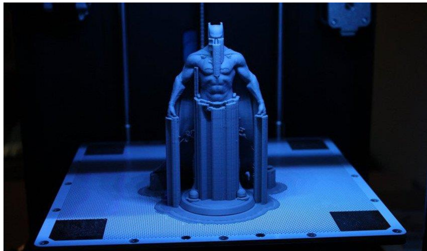
Figura 10. Mesa de impresión Zortrax M200, impresión con soportes. Fuente: 3DNatives
