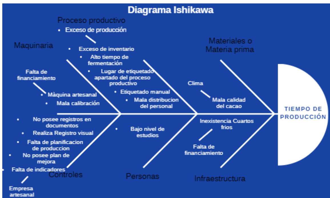
Figura 12 Diagrama de causa-efecto del tiempo de producción del vino del cacao Vincao Elaborado por el autor
