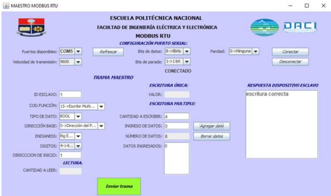
Figura 3.1.31. Prueba de funcionamiento de escritura de múltiples coils con el dispositivo ML1100.
