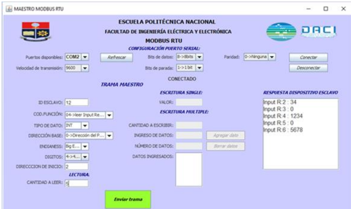
Figura 3.1.8. Prueba de funcionamiento de lectura de registros de entrada con el simulador.
