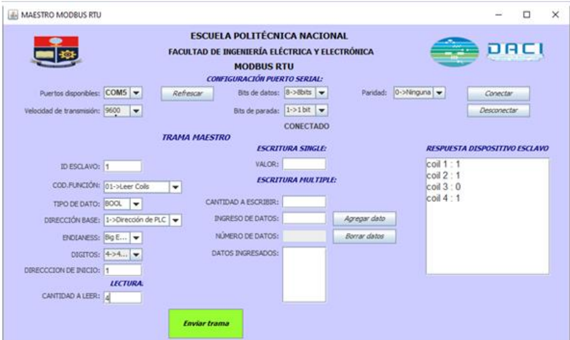
Figura 3.1.19. Prueba de funcionamiento de lectura de coils con el dispositivo ML1100.
