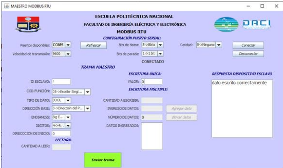
Figura 3.1.27. Prueba de funcionamiento de escritura de un coil con el dispositivo ML1100.
