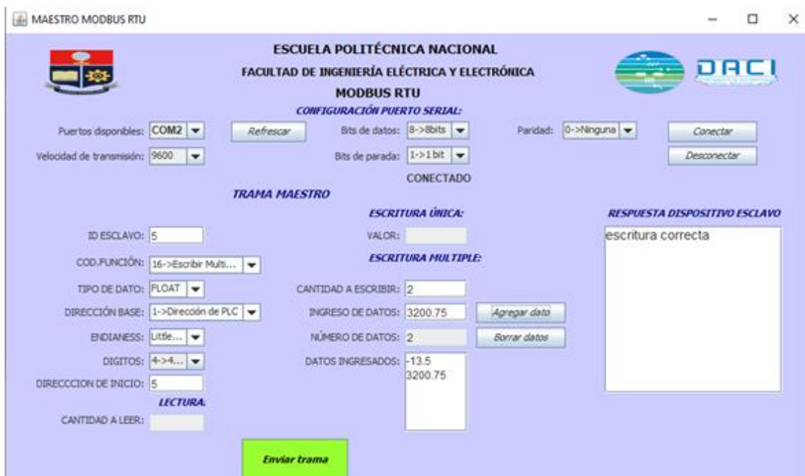
Figura 3.1.14. Prueba de funcionamiento de escritura de múltiples registros holding con el simulador
