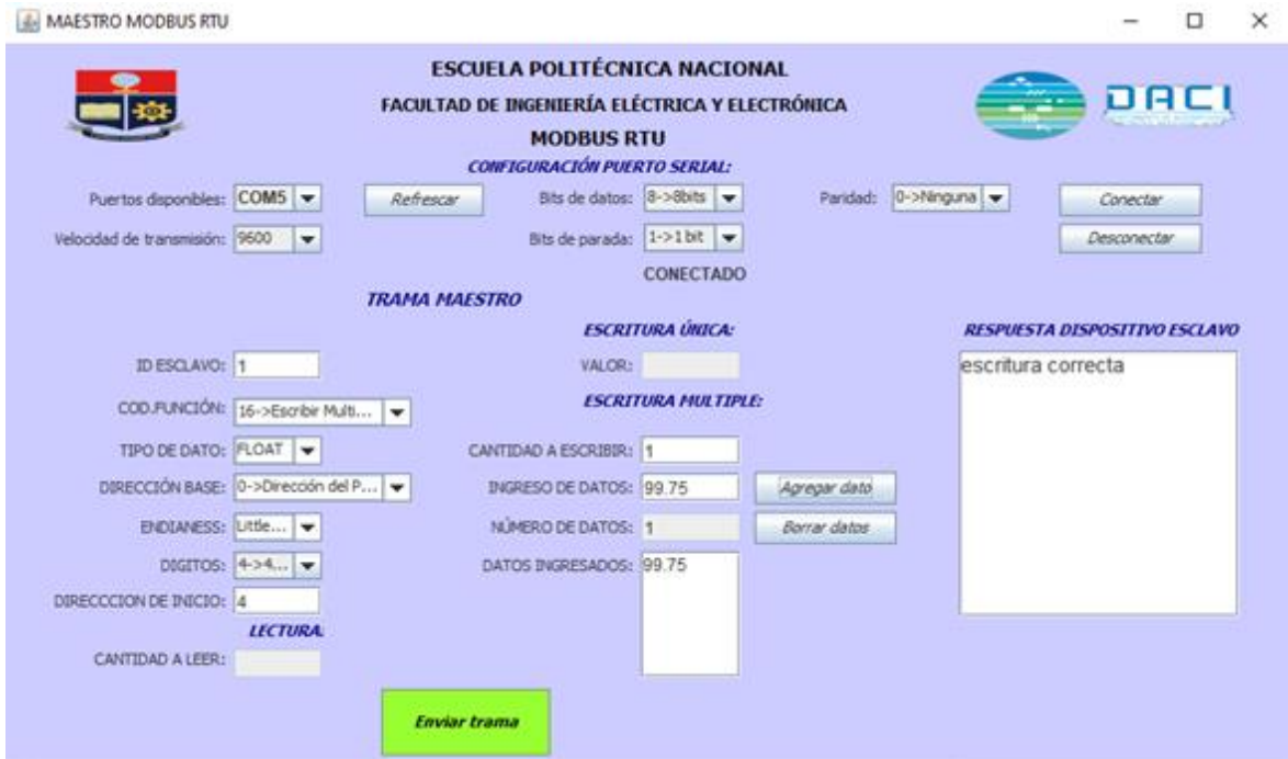
Figura 3.1.33. Prueba de funcionamiento de escritura de múltiples registros holding con el dispositivo ML1100.
