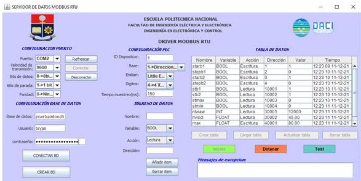
Figura 3.2.15. Ventana servidor de datos MODBUS RTU funcional.
