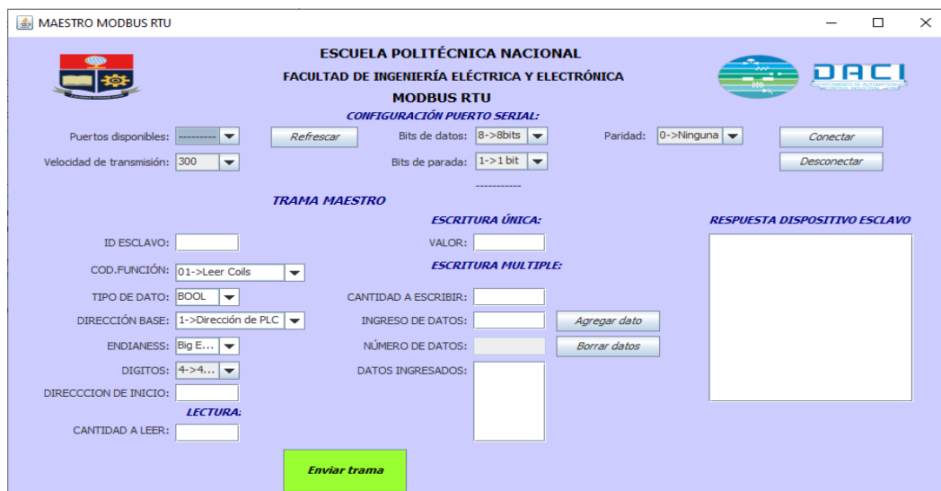
Figura A2.4.2. Ventana Maestro Modbus RTU.
