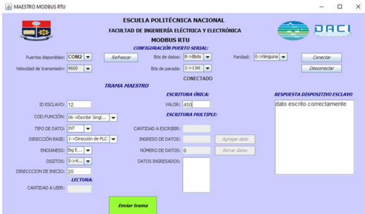
Figura 3.1.12. Prueba de funcionamiento de escritura de un registro holding con el simulador.
