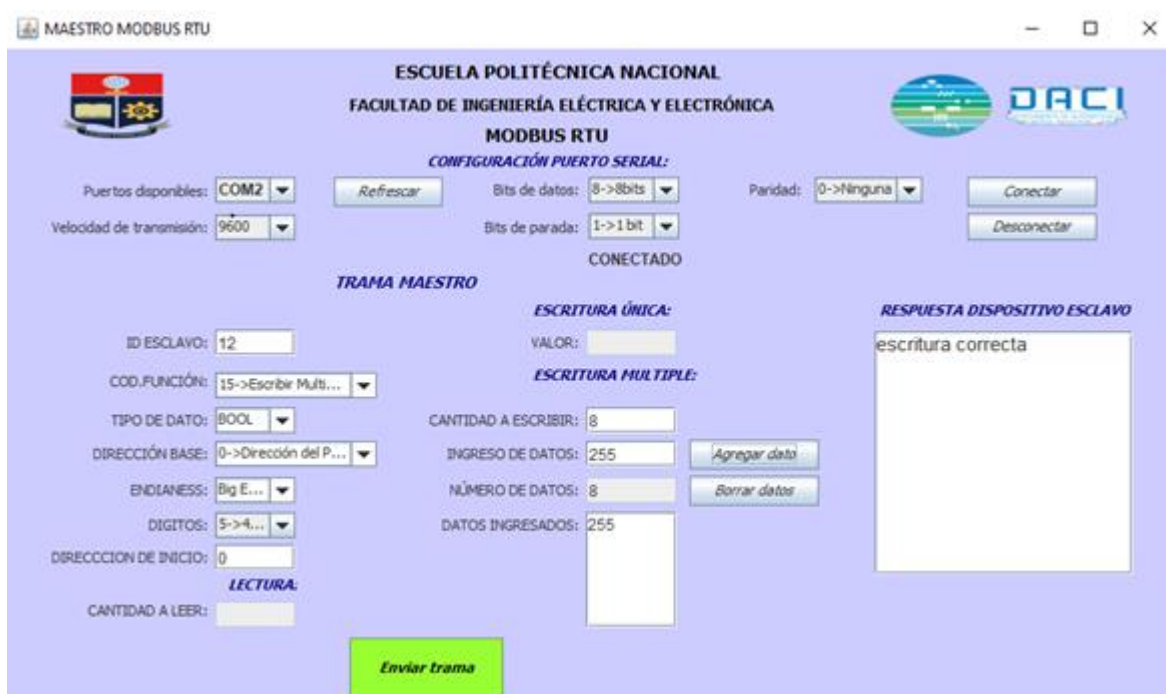
Figura 3.1.14. Prueba de funcionamiento de escritura de múltiples coils con el simulador.
