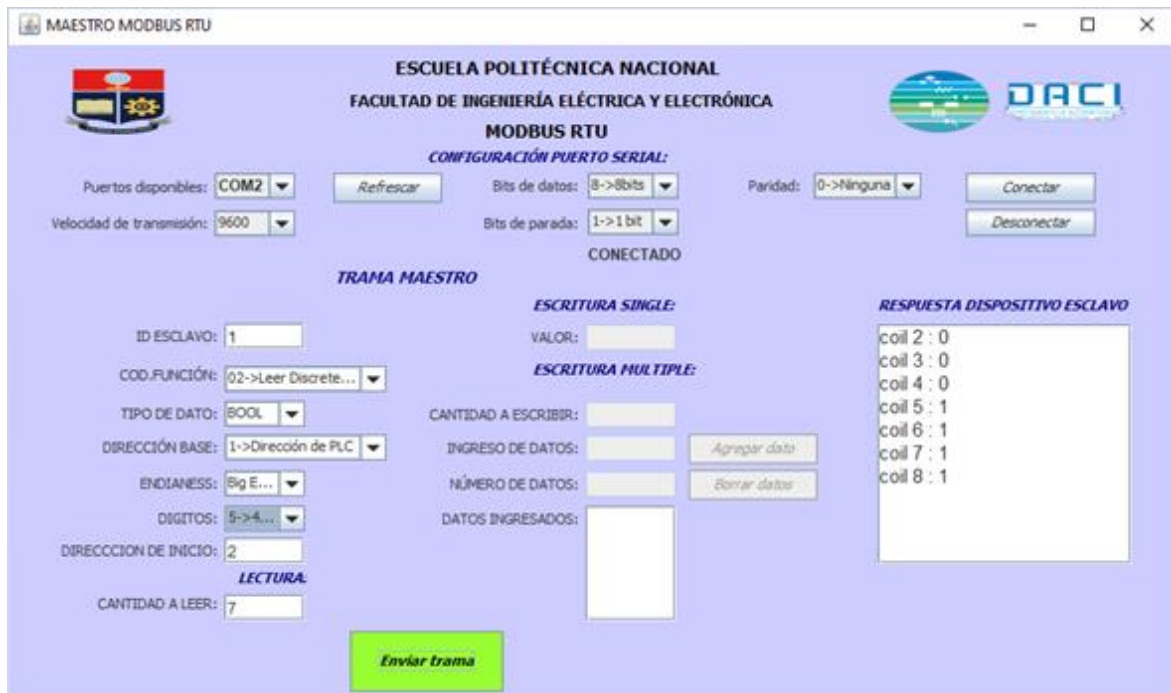
Figura 3.1.4. Prueba de funcionamiento para lectura de contacts con el simulador.
