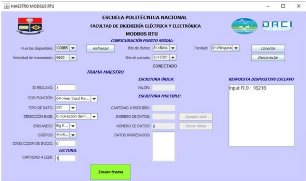
Figura 3.1.25. Prueba de funcionamiento de lectura de registros de entrada con el dispositivo ML1100.
