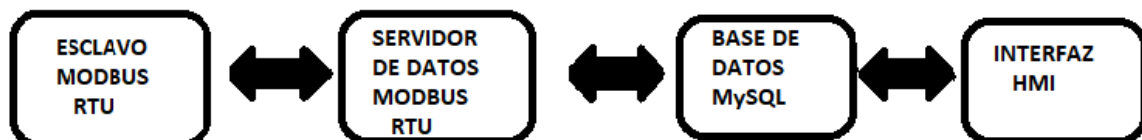
Figura 2.5.6. Modo servidor de datos MODBUS RTU.
