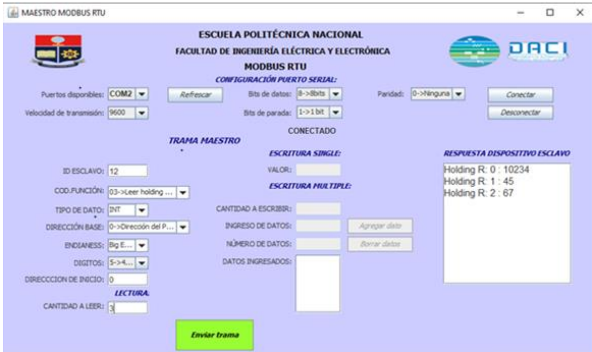
Figura 3.1.6. Prueba de funcionamiento de lectura de registros holding con el simulador. En la parte izquierda se observan los parámetros seleccionados para crear la trama de solicitud por parte del maestro, en la parte derecha se observar la respuesta del esclavo.
