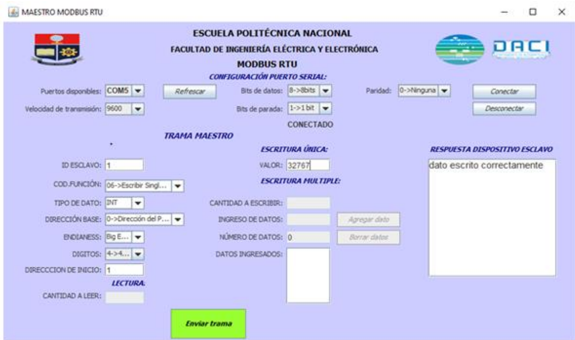
Figura 3.1.29. Prueba de funcionamiento de escritura de un registro holding con el dispositivo ML1100.
