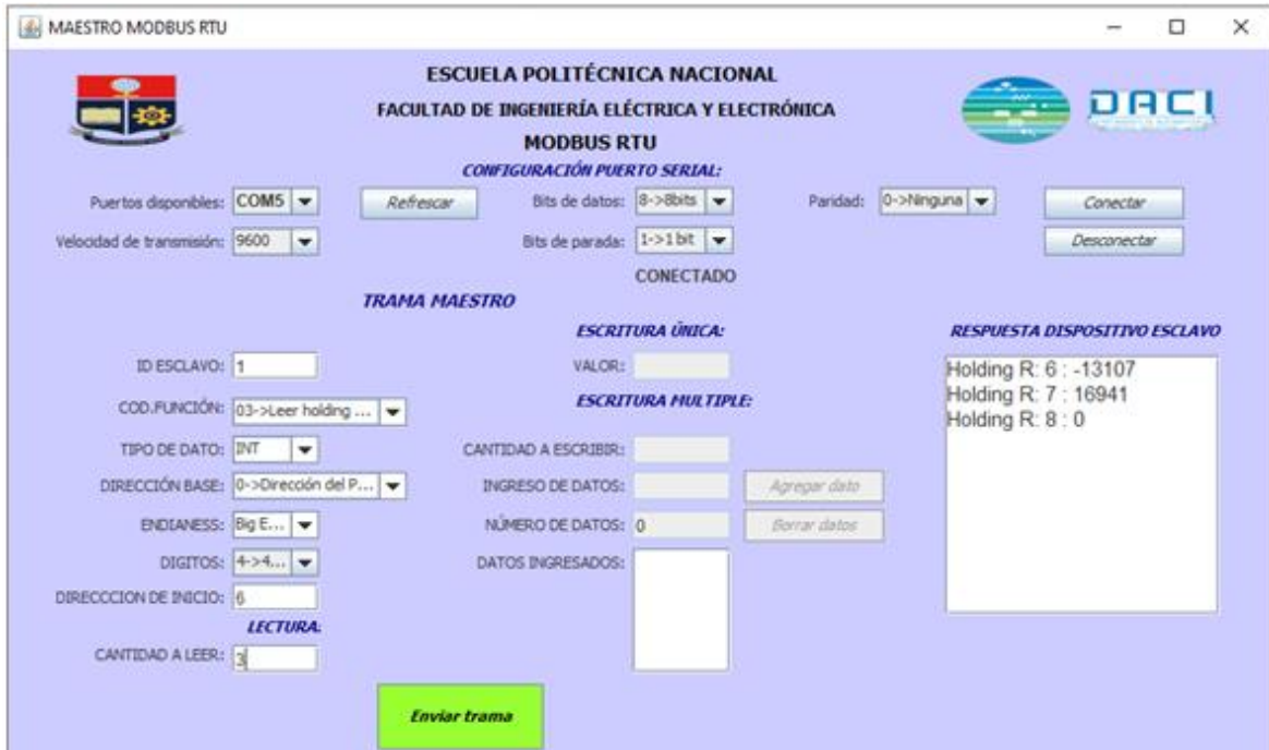
Figura 3.1.23. Prueba de funcionamiento de lectura de registros holding con el dispositivo ML1100.
