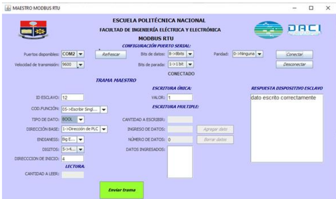
Figura 3.1.10. Prueba de funcionamiento de escritura de un coil con el simulador.
