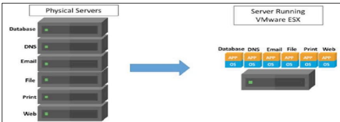
Figura 14. Consolidación de hardware a través de virtualización con VMware ESX. [23]
