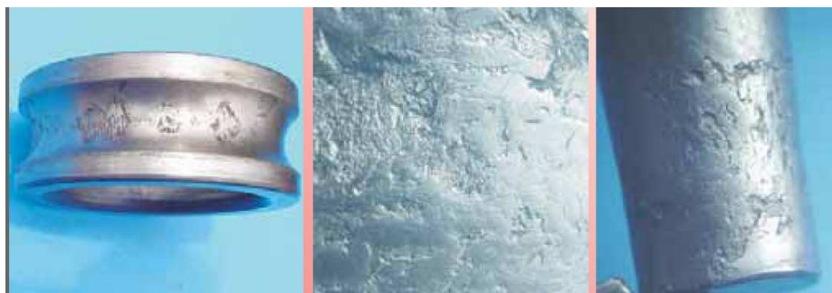
Figura 2.12 Desgaste por fatiga superficial
