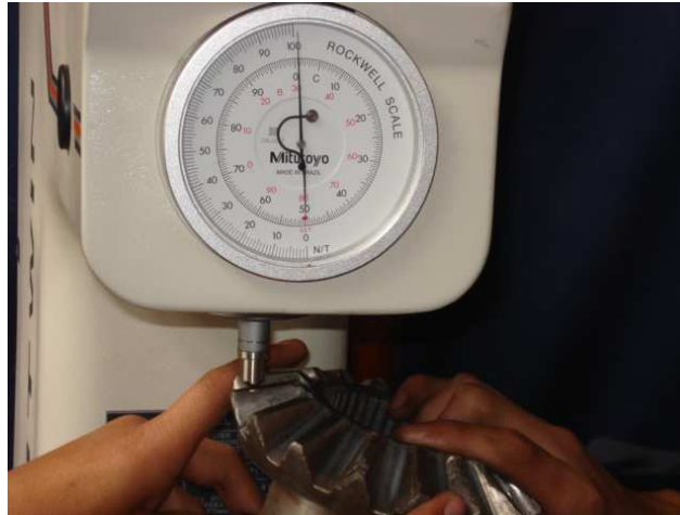
Figura 5.6 Ensayo de dureza rueda dentada cónica Fuente: Laboratorio de Resistencia de Materiales
