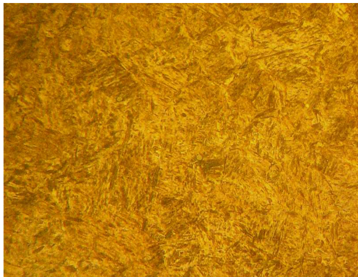
Figura 5.8 Acero aleado de alto contenido de carbono, se observa una estructura completamente martensítica en la matriz del material. (martensita más fina). 400x
