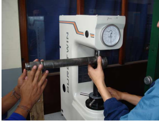
Figura 5.9 Ensayo de dureza eje de transmisión Fuente: Laboratorio de Resistencia de Materiales
