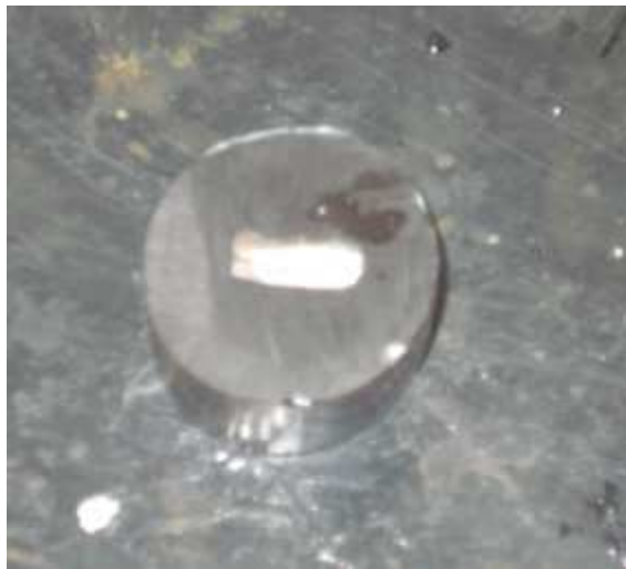
Figura 5.4 Probeta preparada para realizar el ensayo metalográfico
