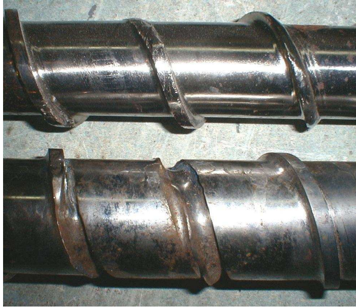
Figura 2.1 Desgaste abrasivo de un tornillo nitrurado. Una vez la cresta se gasta el material blando del alma permite desgaste en forma cóncava
