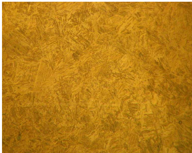
Figura 5.5 Acero tratado térmicamente por temple y revenido, se observa la presencia de martensita. Además se observa en detalle inclusiones de sulfuro de manganeso y silicato. 400x
