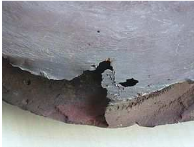
Figura 2.5. Desgaste producido por la cavitación en un rodete de una bomba centrífuga
