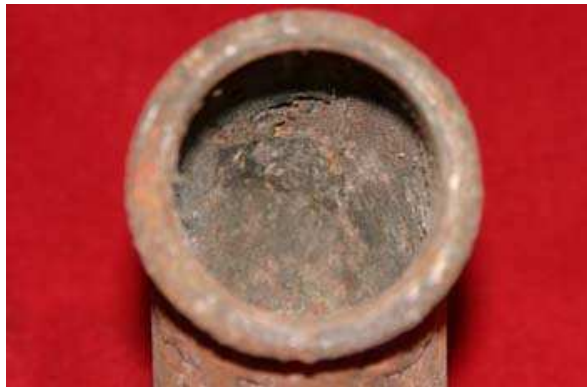
Figura 2.7 Daño por erosión
