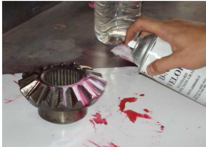
Figura 5.26 Aplicación del Revelador Acuoso
