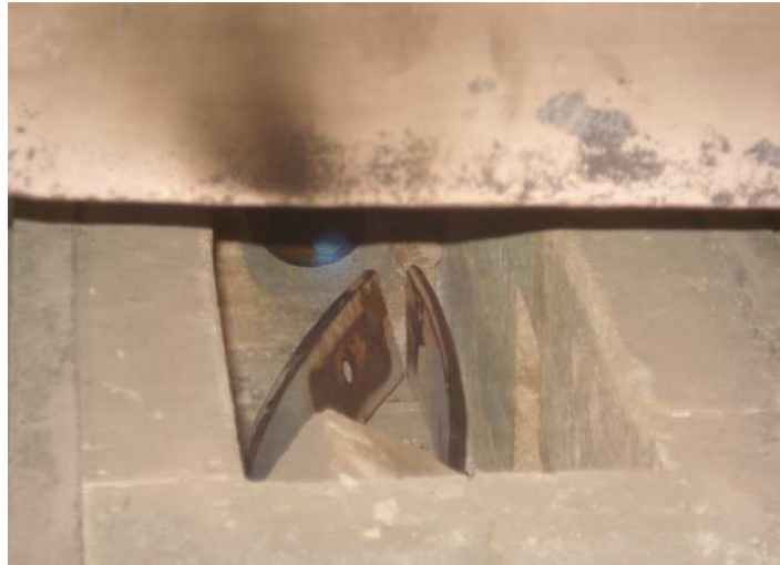
Figura 5.2 Recocido de la ballesta
