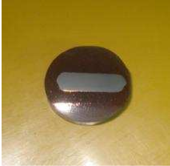
Figura 5.7 Probeta preparada para realizar el ensayo metalográfico
