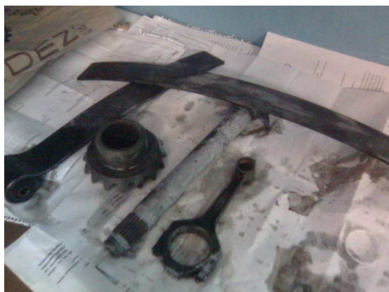
Figura 5.1 Proceso de desoxidación ballesta, rueda dentada cónica y eje de transmisión
