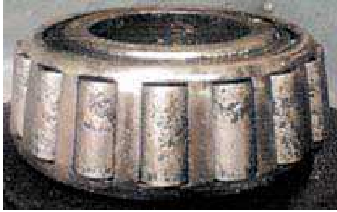
Figura 2.20 Cono del Cojinete con Escamaciones
