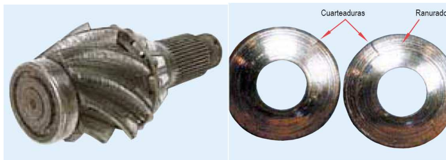
Figura 2.14 Piñón Motriz – Bajo Lubricante y Rondanas de Empuje del Piñón Lateral – Rayado Fuente: www.docentes.unal.edu.co
