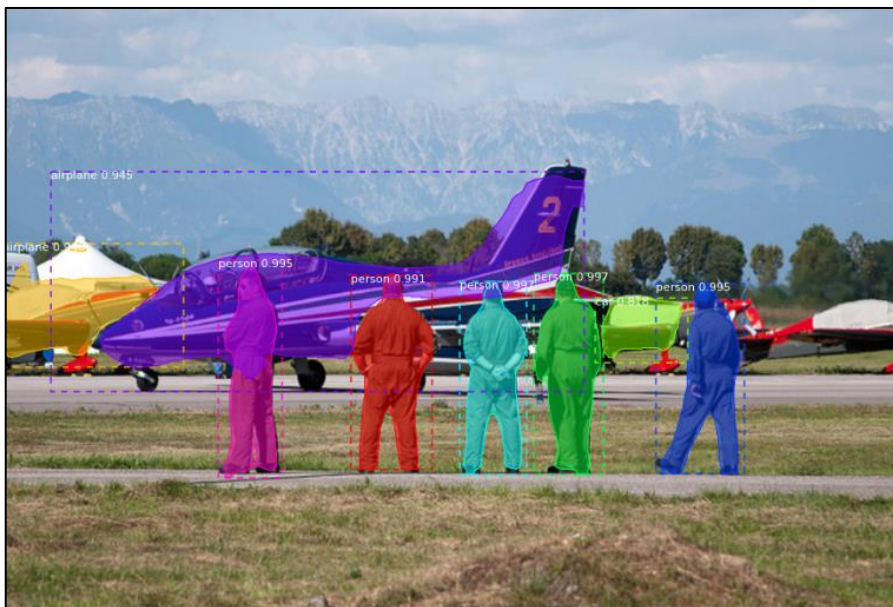
Figura 14. Ejemplo de implementación del modelo Mask R-CNN [43].
