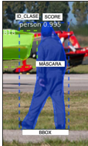
Figura 23. Atributos mediante la implementación de Mask R-CNN sobre un objeto.
