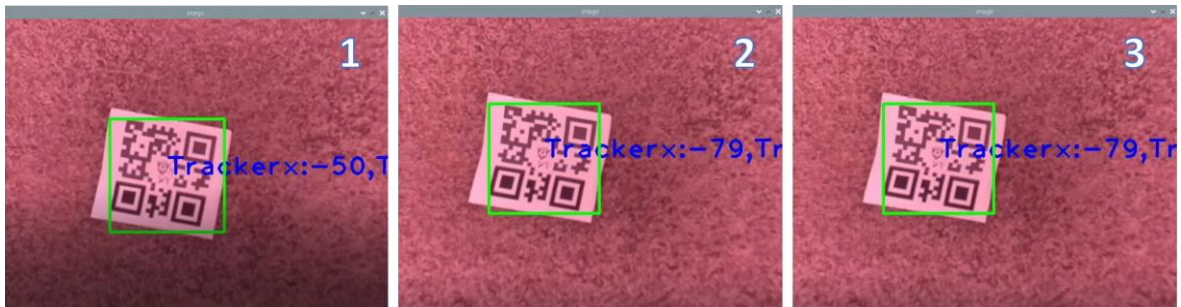
Figura III.11. Seguimiento del helipuerto en la prueba 2 – Sistema de Visión Artificial.
