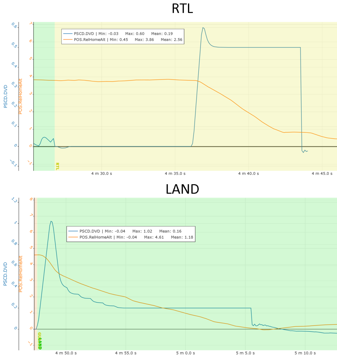
Figura 3.14. Aterrizaje durante los modos de vuelo RTL (sin apoyo del prototipo auxiliar) y LAND (con apoyo del prototipo auxiliar)
