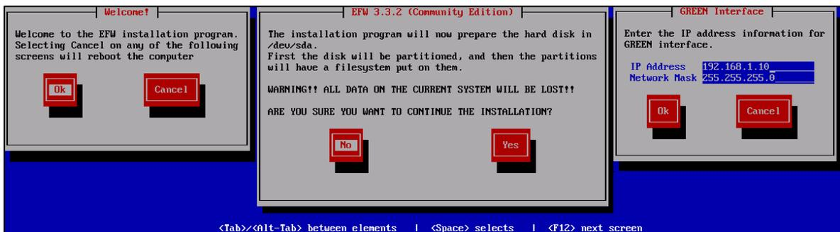
**Figura 2.5.** Pantallas principales de instalación de Endian
