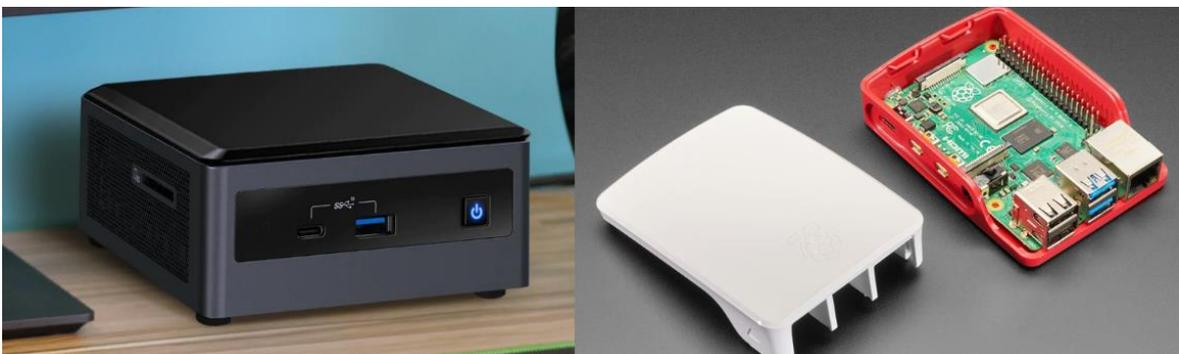
**Figura 1.5.** Intel NUC (izquierda) y Raspberry Pi (derecha)
