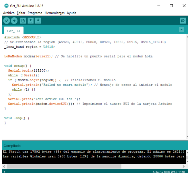
Figura 2.31 Código para obtener el número EUI de la tarjeta Arduino MKRWAN 1310.
