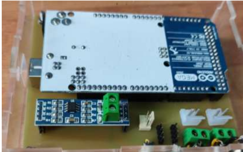
Figura 2.27 Ubicación de los componentes dentro de la placa de control
