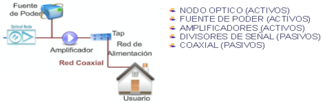
Figura 9. Red de distribución para redes HFC
