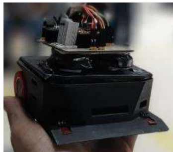
Figura 1.3. Robot mini sumo SIT-UV [13].
