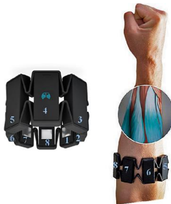
Figura 1.2 Colocación del sensor Myo Armband [1]
