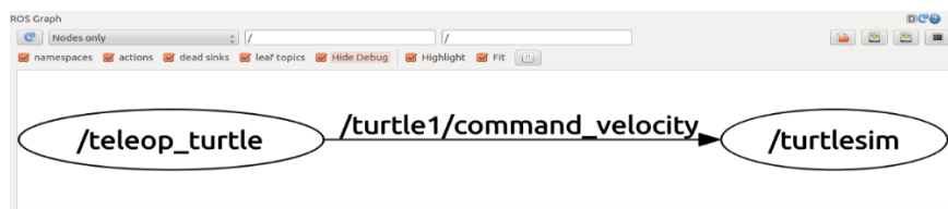
Figura I.4 Arquitectura del entorno de ROS en rqt_graph
