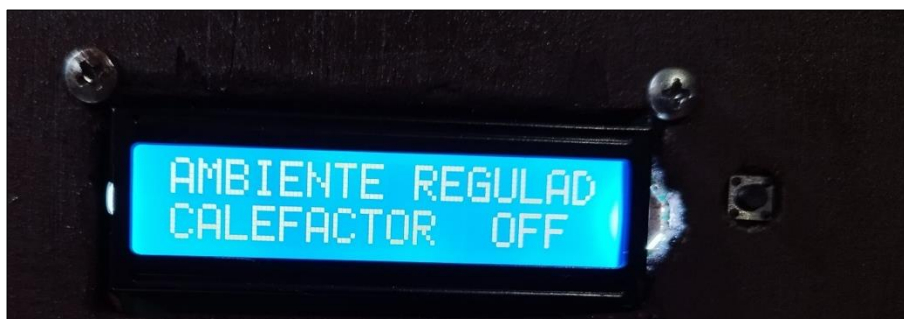
Figura 3.17 Apagado del sistema de calefacción indicando que la regulación del ambiente ha sido exitosa.
