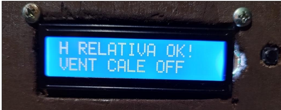
Figura 3.10 Mensaje indicado cuando el valor de la humedad relativa se encuentra dentro del rango establecido.
