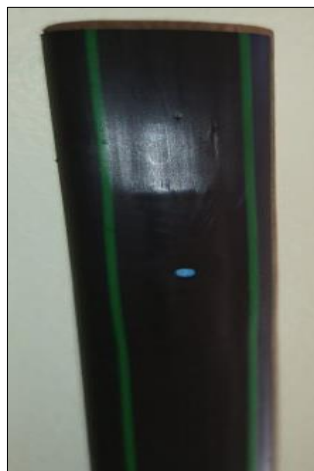
Figura 2.7 Manguera utilizada en sistemas de riego por goteo que presenta un orificio cada cierta distancia para un riego tipo gota.
