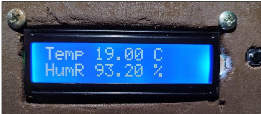
Figura 3.12 Sistema de soporte vital. Mensaje con nuevos valores de temperatura y humedad relativa.
