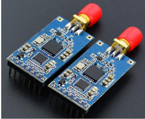
Figura 2.9. Módulo Lora DRF1276DM [30]
