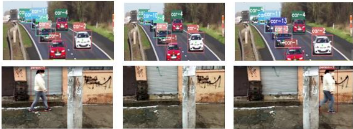
Figura 3.7. Repuesta Algoritmo de seguimiento Deep Sort Fila a) Seguimiento carros en carretera concurrida Fila b) Oclusión total del objeto de interés
