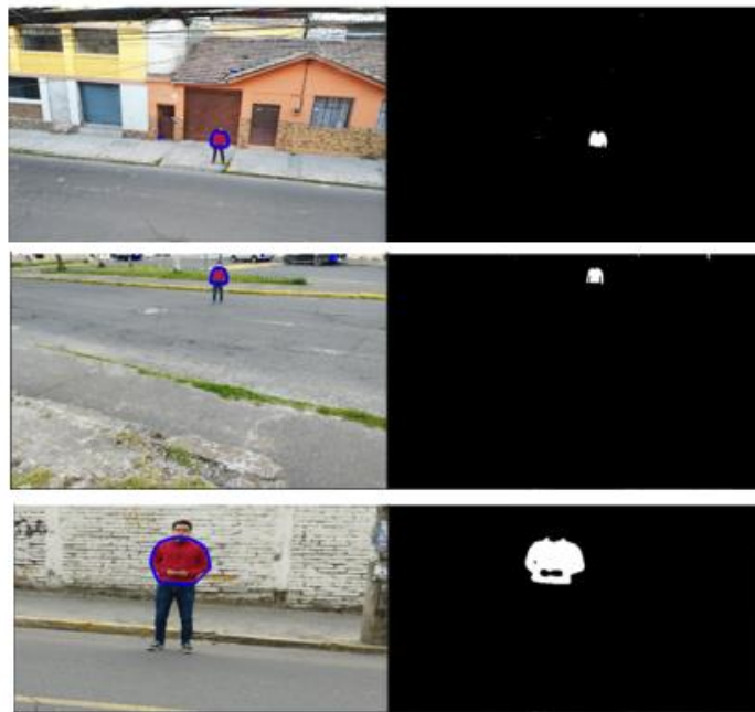
Figura 3.3. Resultados filtro de color con imágenes tomadas a distintas alturas a) 6m b) 4m c) 2m, para determinar el área que comprende el color deseado.
