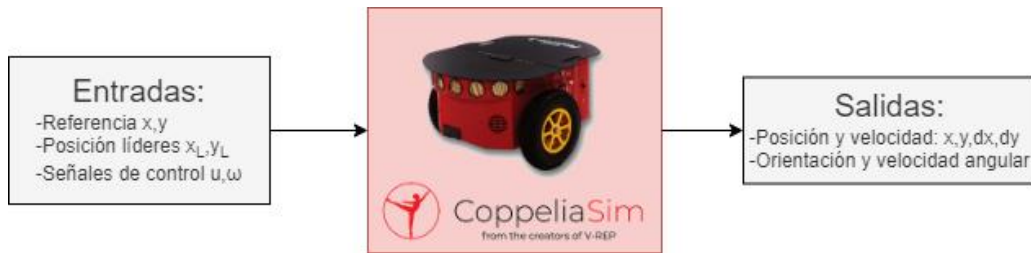
Figura 2.7. Bloque Level-2 MATLAB s-function [Autoría propia].
