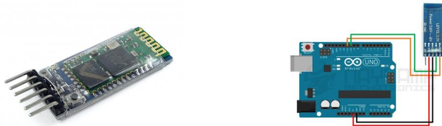
Figura 2.22 Módulo HC-05 [19] Figura 2.23 Conexión Arduino y modulo HC-05 [19]
