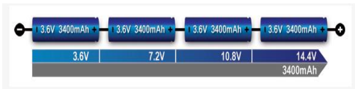
Figura 1.4. Conexión serie de 4 celdas (4s). [13]
