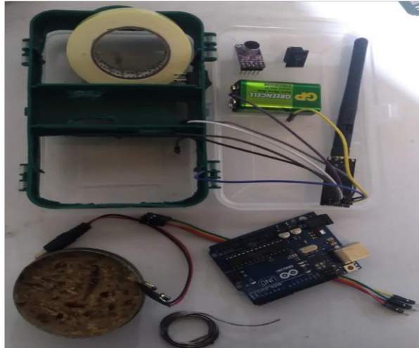
Figura 2.3.7.3 Estructura base y elementos del Nodo sensor o mota. Fuente: Autor
