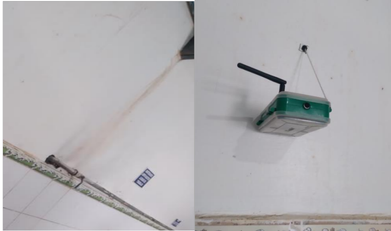
Figura 3.1.5. (a) y (b) Ubicación seleccionada y fijación del nodo sensor 2, respectivamente, de la instalación del nodo sensor 2 en el área 2. Fuente: Autor
