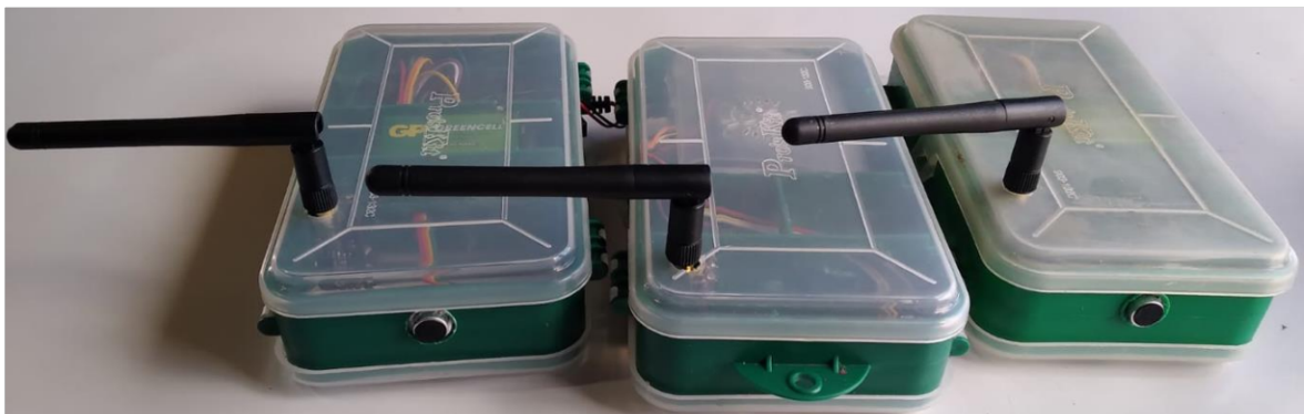
Figura. 2.3.7.8. Red de sensores inalámbrica implementada. Fuente: Autor
