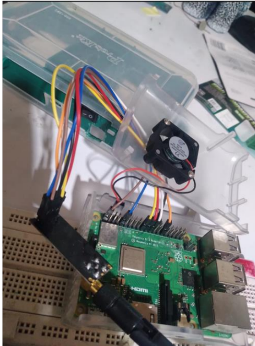
Figura 2.3.7.5 Estructura base y Nodo Recolector o sink. Fuente: Autor
