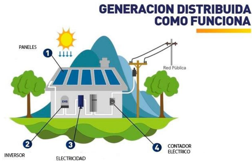
**Figura 2.** Esquema de Generación Distribuida. [14]
