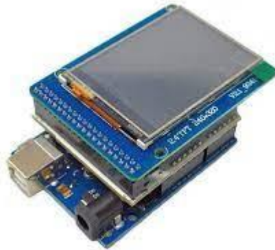
Figura 21. Pantalla TFT Shield montada en placa Arduino Uno
