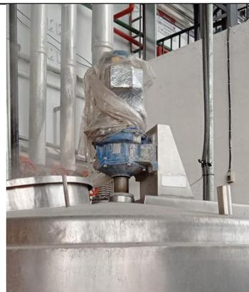
**Figura 2.11.** Motor sin protección de temperatura “Área antiguos silos”.
