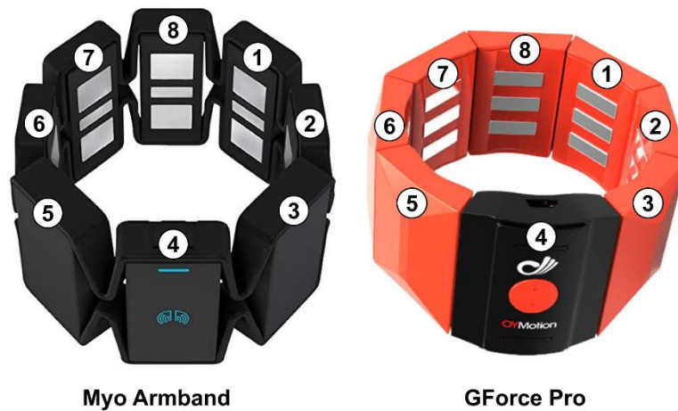
Figura 3 Mapeo de canales enumerado en los sensores Myo Armband y GForce Pro.
