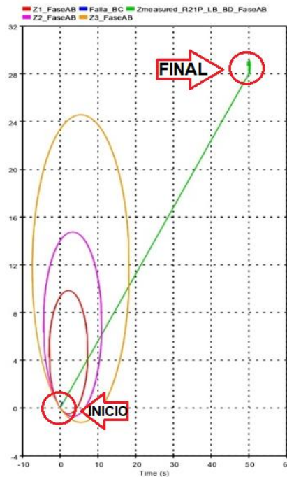
Figura 3.16 Recorrido de la simulación en el Dominio del Tiempo dentro de EMTP-RV
