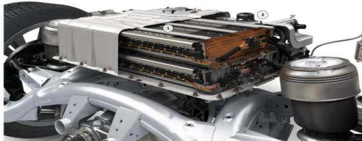
**FIGURA 1.8 BATERÍAS DE NIQUEL-HRIDURO METÁLICO EN EL BMW ACTIVEHYBRID X6**
