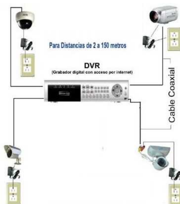
Figura 2.7 Sistema CCTV con Cable Coaxial. [F7]
