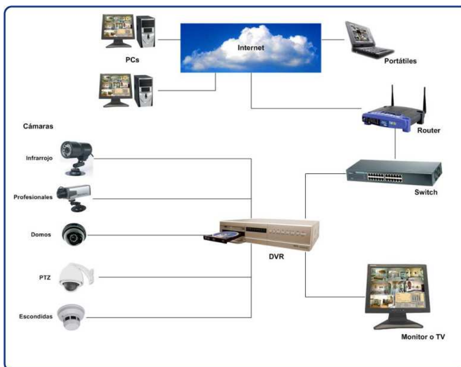
Figura 2.4 Sistema CCTV de Segunda Generación. [F4]
