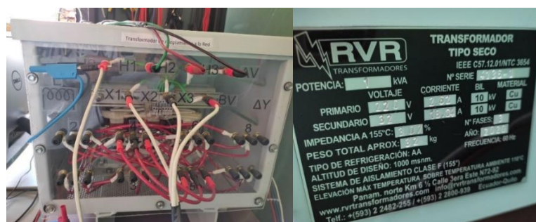
Figura 20. Transformador de acoplamiento a la res y placa de datos
