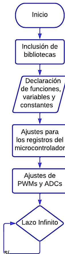
Figura 21. Diagrama de flujo del sistema de control del inversor de potencia
