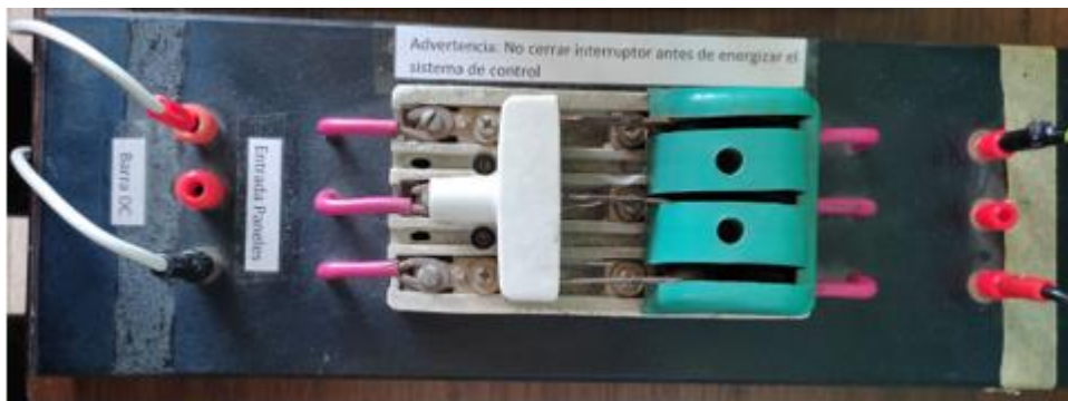
Figura I. 1. Interruptor de cuchillas de la barra DC
